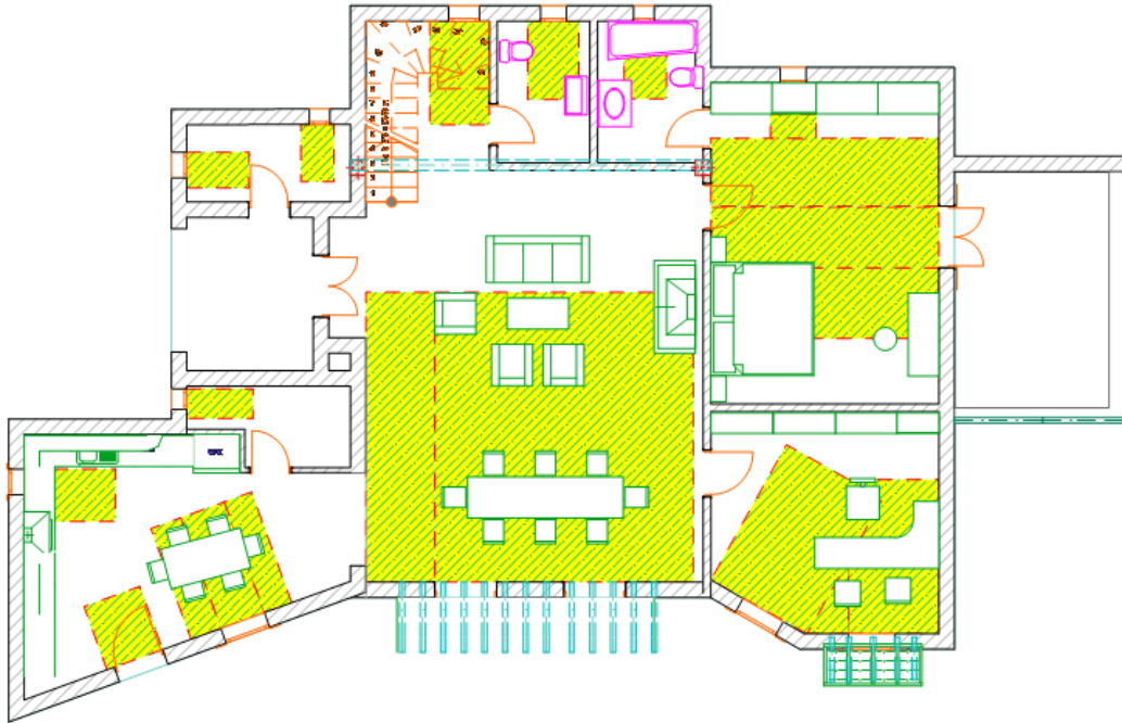
Εικόνα 77 : Ζώνες ελέγχου φυσικού φωτισμού στο ισόγειο. (πηγή: Επεξεργασία ίδια με το λογισμικό ArchiCAD)
