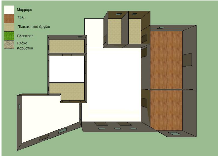
Εικόνα 40: Τύπος τοποθετούμενων δαπέδων ισόγειου (πηγή: Πρωτότυπη με τη χρήση του λογισμικού SketchUP)
