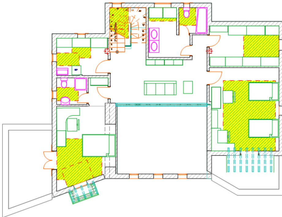
Εικόνα 78 : Ζώνες ελέγχου φυσικού φωτισμού στον όροφο. (πηγή: Επεξεργασία ίδια με το λογισμικό ArchiCAD)
