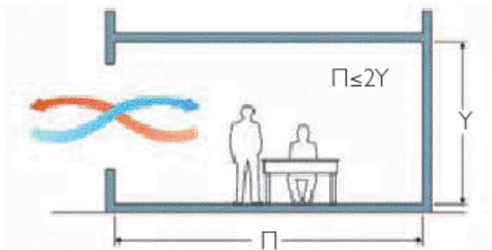
Εικόνα 67 : Περιοχή επιρροής μονόπλευρου φυσικού αερισμού με ένα άνοιγμα. (πηγή: Οδηγός Ενεργειακού Σχεδιασμού, ΚΤΙΡΙΟ, 2011)
