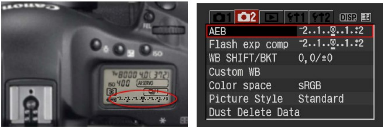
Εικόνα 3.15: Ρύθμιση παραμέτρων του Auto Exposure Bracketing σε μηχανή Canon Mark III (canon.com)
