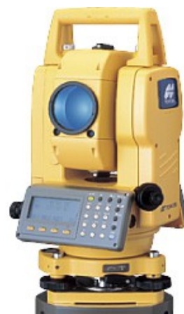
Εικόνα 5.13: Ο ολοκληρωμένος γεωδαιτικός σταθμός Topcon GPT-3003LN ( topcon.co.jp )
