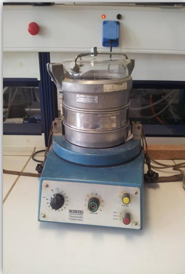
Εικόνα 6.6: Η διάταξη των κοσκίνων που χρησιμοποιήθηκε.
