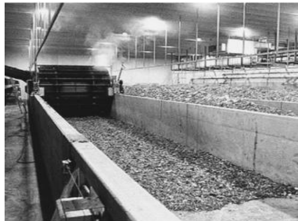
Εικόνα 2.12: Τυπική διάταξη οριζόντιων κλειστών συστημάτων κομποστοποίησης, τύπου καναλιών (Turovskiy and Mathai, 2006; Diaz et al., 2002)
