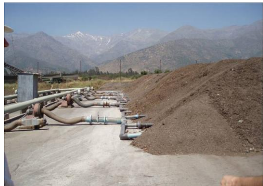
Εικόνα 2.15: Τυπική διάταξη οριζόντιου ανοιχτού συστήματος κομποστοποίησης, τύπου αεριζόμενων στατικών σωρών (Diaz et al., 2007, 2002)
