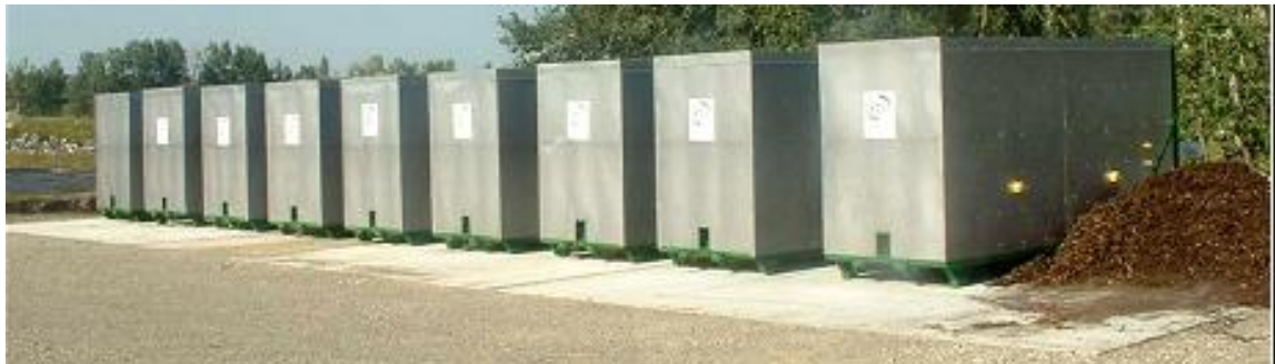
Εικόνα 2.10: Τυπική διάταξη οριζόντιων κλειστών συστημάτων κομποστοποίησης, τύπου κιβωτίων, σε παράλληλα στοιχεία
