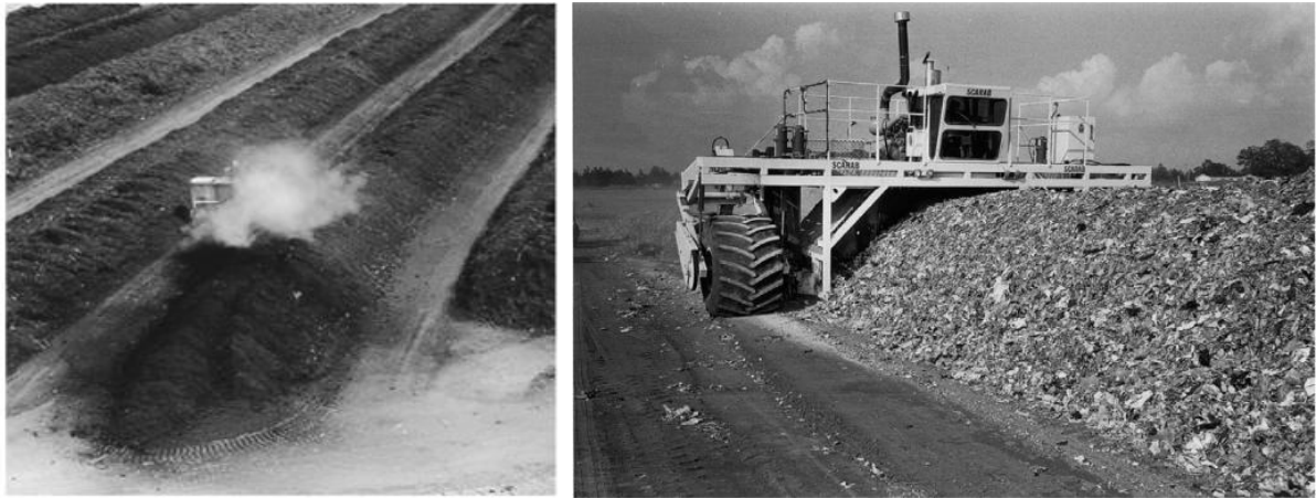
Εικόνα 2.14: Τυπική διάταξη οριζόντιου ανοιχτού συστήματος κομποστοποίησης, τύπου αναστρεφόμενων σειραδιών (Diaz et al., 2002)
