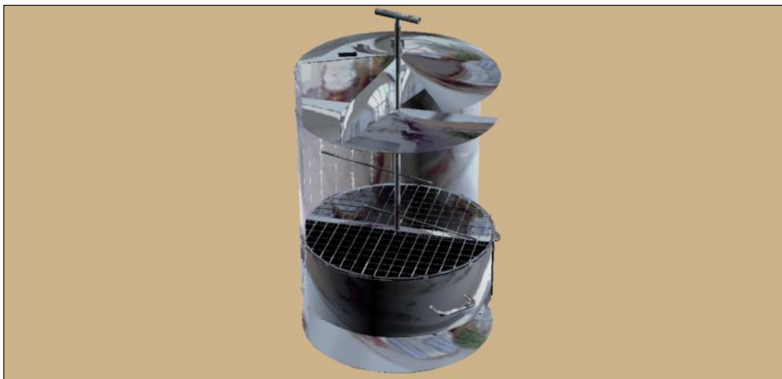
Εικόνα 4.37 Εσωτερικό οικιακού κομποστοποιητή (ανοικτό πώμα, αναδευτήρας σε κίνηση)
