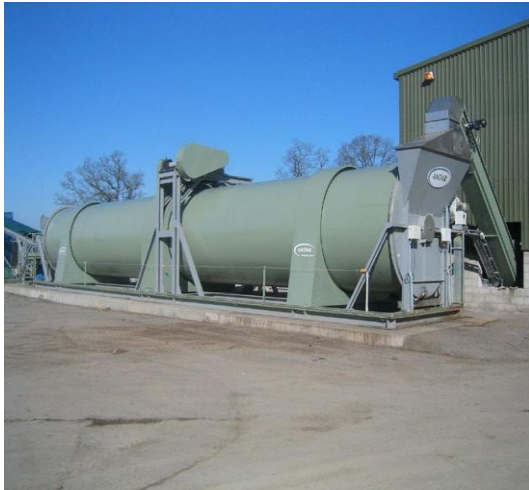
Εικόνα 2.13: Τυπική διάταξη οριζόντιου κλειστού συστήματος κομποστοποίησης, τύπου περιστρεφόμενου τυμπάνου (Diaz et al., 2002)
