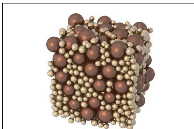
Εικόνα 3.12 Τρισδιάστατη προσομοίωση πλήρωσης όγκου με 30% [ \text{m}^3/\text{m}^3 ] σφαίρες διαμέτρου 4 mm και 70% [ \text{m}^3/\text{m}^3 ] σφαίρες των 10 mm (Fennis, 2011).
