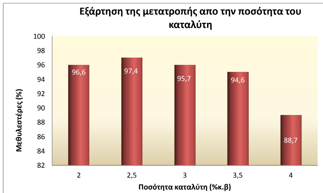
Διάγραμμα 11.6: Επιρροή του ποσοστού καταλύτη στην ποσότητα των μεθυλεστέρων που δημιουργούνται, σε συνθήκες αντίδρασης αναλογία μεθανόλης/ελαίου 12:1, σε θερμοκρασία 60°C, για 2h.
