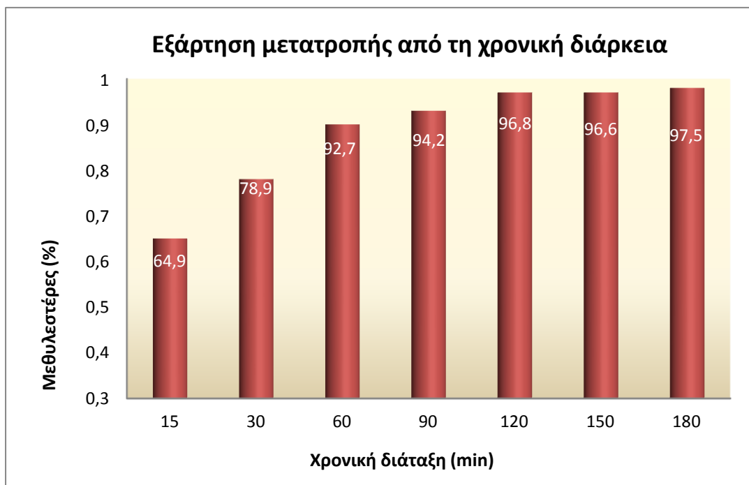
Διάγραμμα 7.7: Επιρροή της ποσότητας μεθυλεστέρων στο βιοντήζελ από τη χρονική διάρκεια της αντίδρασης. Οι υπόλοιπες συνθήκες είναι: ποσοστό καταλύτη 3,5%, αναλογία μεθανόλης/ελαίου 15:1 και σε θερμοκρασία 60° C .
