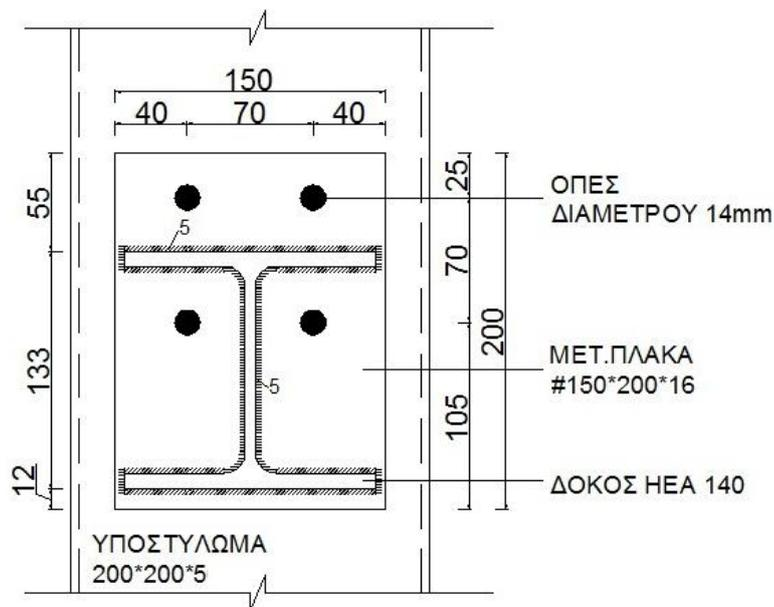
Σχήμα 4.5: Λεπτομέρειες διάταξης οπών και δοκού στη μετωπική πλάκα.
