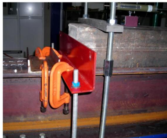
Σχήμα 4.10: Μέτρα εξασφάλισης κοιλοδοκού έναντι ολίσθησης και στροφής.
