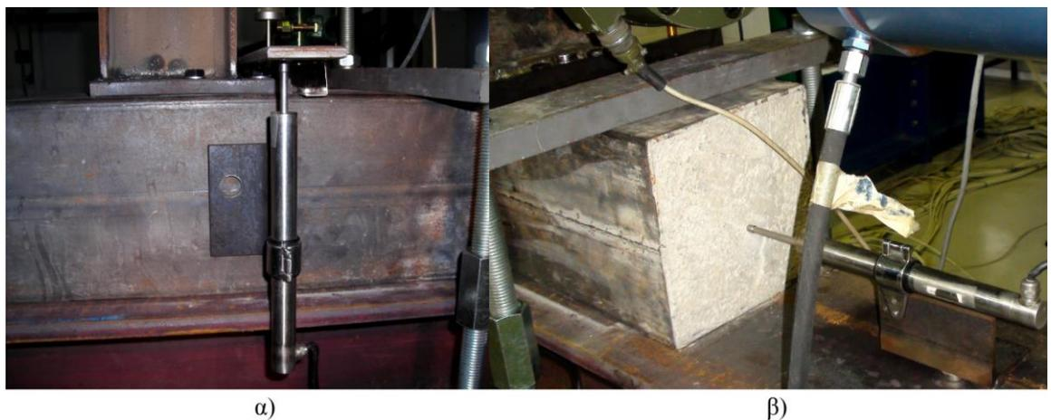
Σχήμα 4.14: α) LVDT-30 και β) LVDT-31
