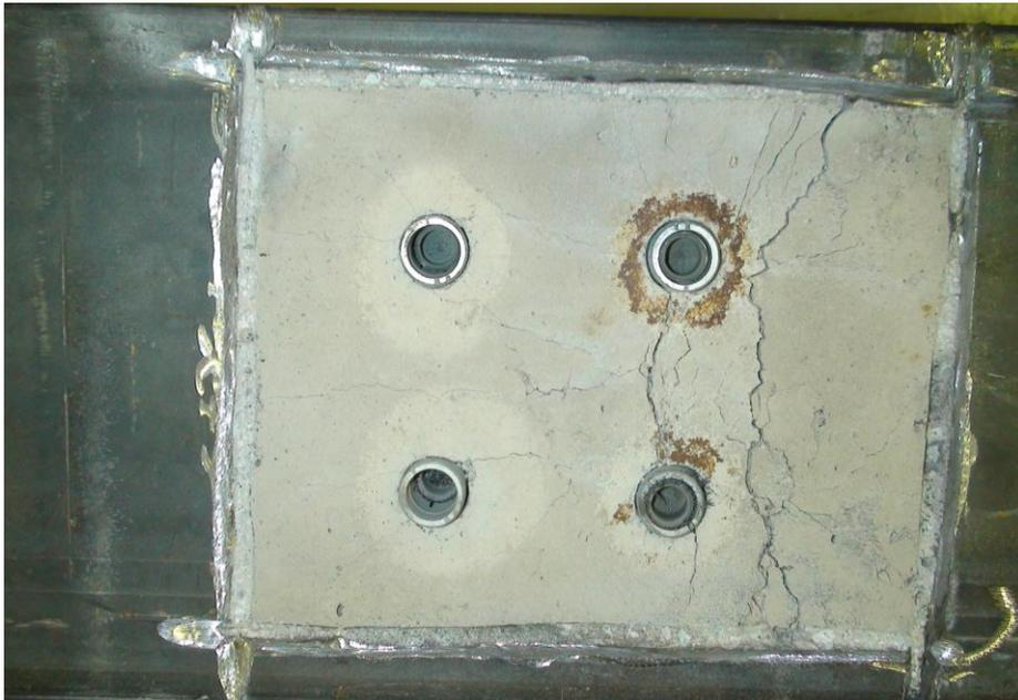
Σχήμα 5.13: Εικόνα του εσωτερικού του υποστύλωματος, όπου είναι εμφανής η έντονη ρηγμάτωση που υπέστη το σκυρόδεμα κατά την 3<sup>η</sup> δοκιμή.
