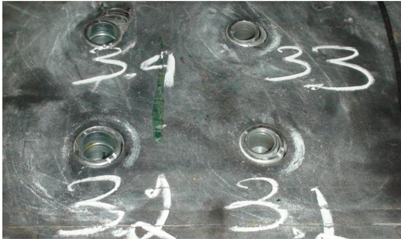
Σχήμα 5.12: Το υποστύλωμα με τα εξωτερικά περιβλήματα των αγκυρίων, μετά τη λήξη της δοκιμής.
