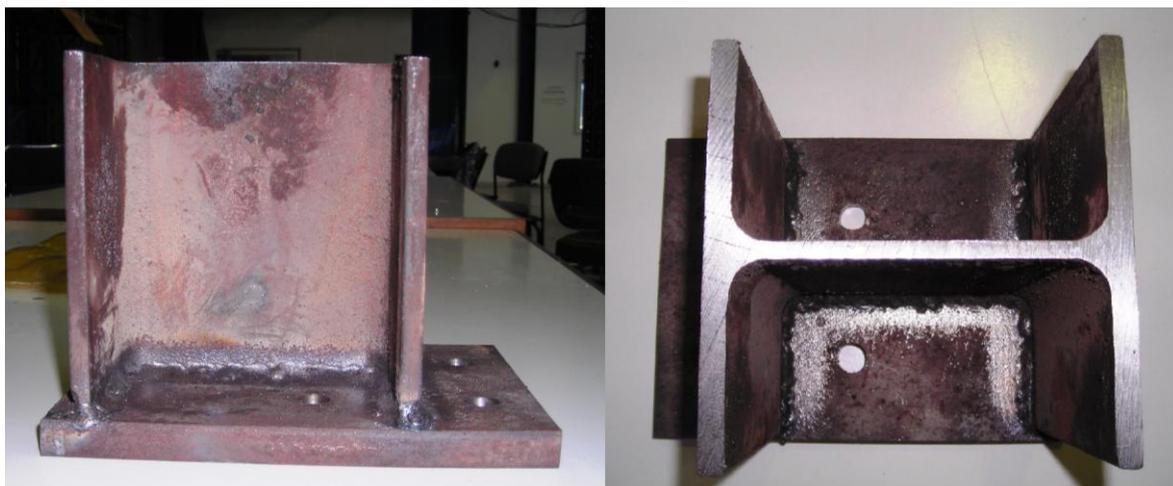
Σχήμα 4.7: Συγκόλληση μετωπικής πλάκας – δοκού (για το 1<sup>ο</sup> πείραμα).
