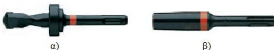
Σχήμα 4.8: Εργαλεία τοποθέτησης αγκυρίων: α)τρυπάνι με μηχανικό τέρμα διαμέτρου 20mm και μήκους 68,8mm, β)εργαλείο τοποθέτησης για αυτόματη υποσκαφή [12].
