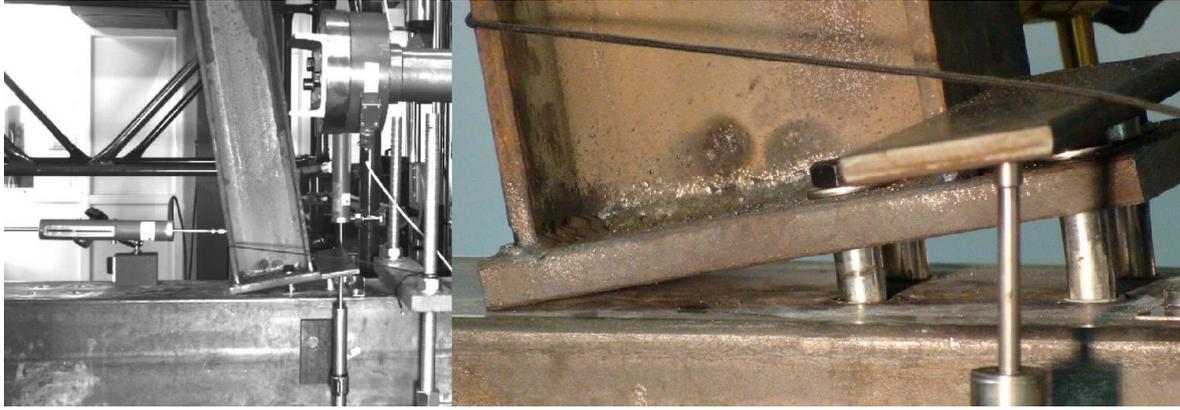
Σχήμα 5.11: Εικόνα της σύνδεσης, λίγο πριν την ολοκληρωτική της αστοχία.
