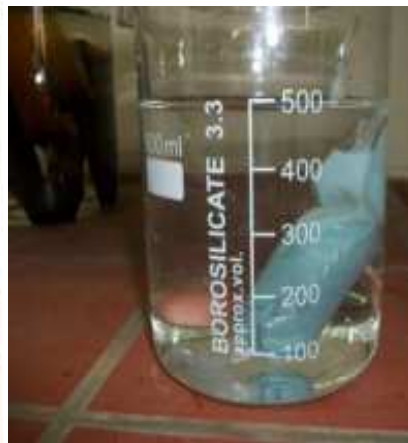
Εικόνα 4.2: Εξουδετέρωση του διαλύματος νιτρικού χρωμίου και τοποθέτηση του πολφού σε σωλήνες διαπίδυσης.
