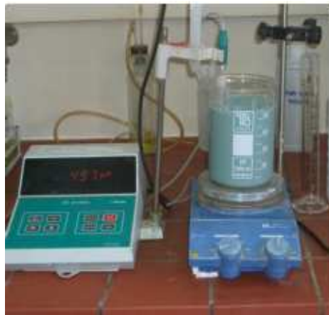
Εικόνα 4.2: Εξουδετέρωση του διαλύματος νιτρικού χρωμίου και τοποθέτηση του πολφού σε σωλήνες διαπίδυσης.
