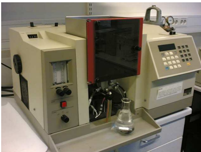
Εικόνα Ι.1. Συσκευή Ανάλυσης AAS
