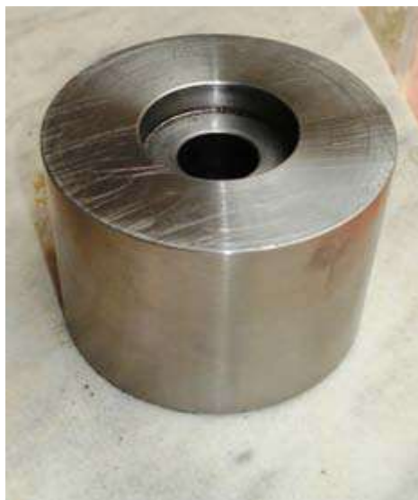
Εικόνα 4. 1: Τμήμα εξόδου της μήτρας, φέρων διαμόρφωση για την τοποθέτηση του κωνικού δακτυλίου.
