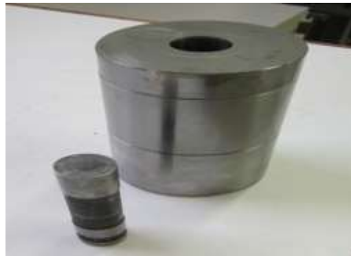
Εικόνα 4. 7: Συναρμολογημένου συνόλου των εξαρτημάτων της μήτρας και έμβολο
