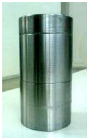
Εικόνα 4. 5: Άποψη του συναρμολογημένου συνόλου των εξαρτημάτων της μήτρας
