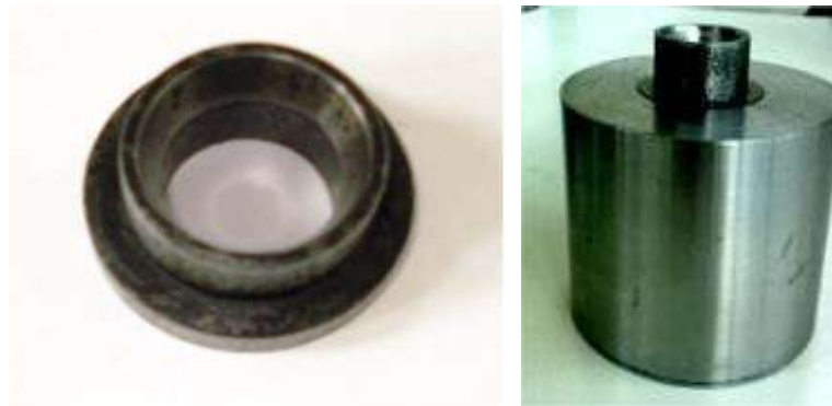
Εικόνα 4. 2: Κωνικό τμήμα της μήτρας και άποψη του συνόλου «τμήμα εξόδου-κωνικό τμήμα»
