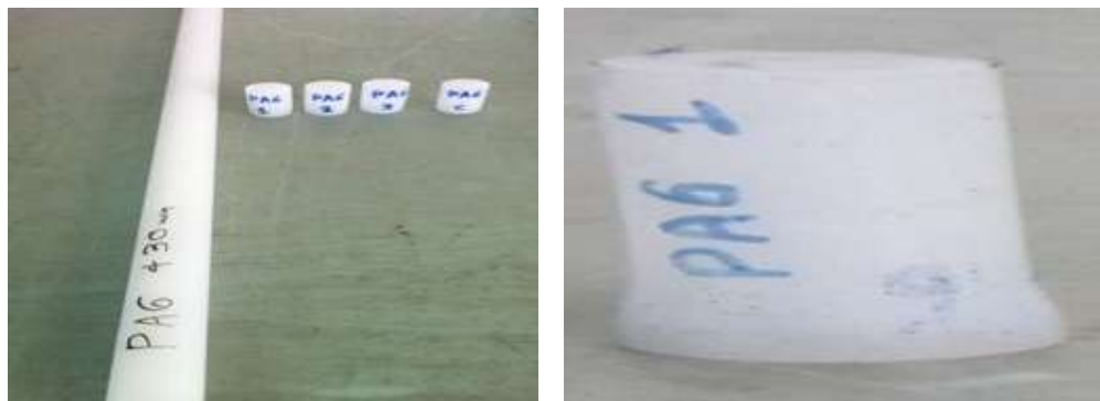
Εικόνα 5. 3: Μορφή των δοκιμών από PA-6 πριν και μετά την διέλαση
