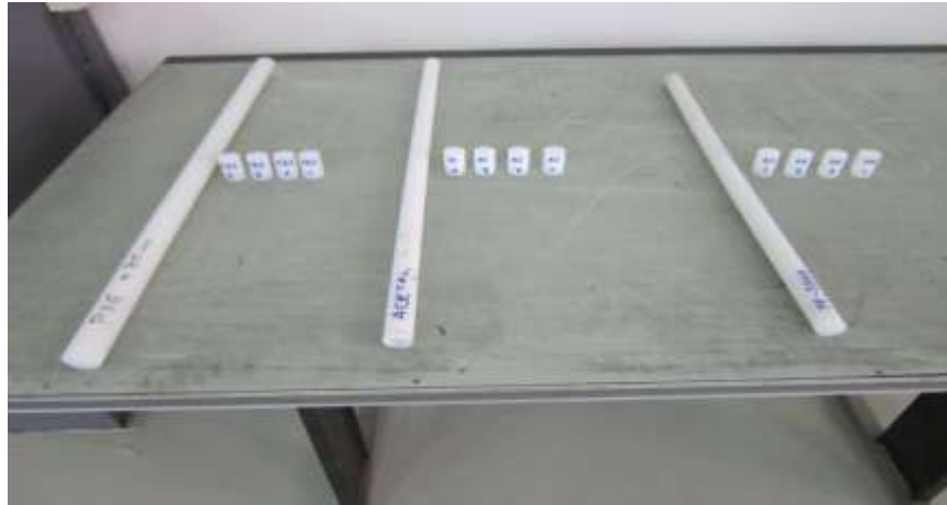
Εικόνα 5. 1: Κυλινδρικά δοκίμια από PE-1000, PA-6 και ACETAL
