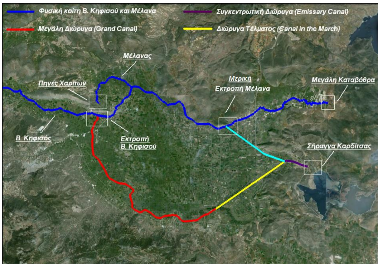
Σχήμα 4.1 Η διαμόρφωση των κοιτών του Βοιωτικού Κηφισού και του Μέλανα στο πλαίσιο των αποξηραντικών έργων του νέου ελληνικού κράτους στην Κωπαΐδα. Προέλευση: Κουντούρη κ.α. (2012) μετά από προσαρμογή.
