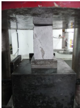
Σχ.4.2.1.5 Δ1 τοποθετημένο στη μηχανή θλίψης
