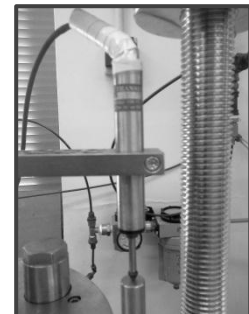
εικόνα 3-4 : Εξωτερικό μηκυσιόμετρο – LVDT.
