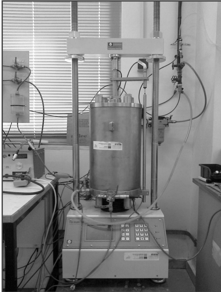
εικόνα 3-1 : Το πλαίσιο φόρτισης της τριαξονικής συσκευής.
