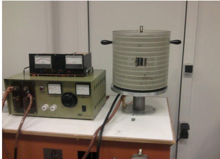
Σχήμα 5-2: Θερμικός εξαχνωτής, όπου γίνεται η εναπόθεση του Αλουμινίου.
