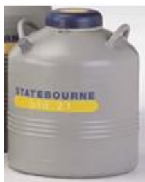
Εικόνα 6.3: Δοχείο Υγρού Αζώτου [37]
