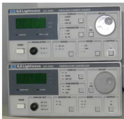
Εικόνα 6.9: Το τροφοδοτικό της διόδου (πάνω) και ο ελεγκτής θερμοκρασίας (κάτω)
