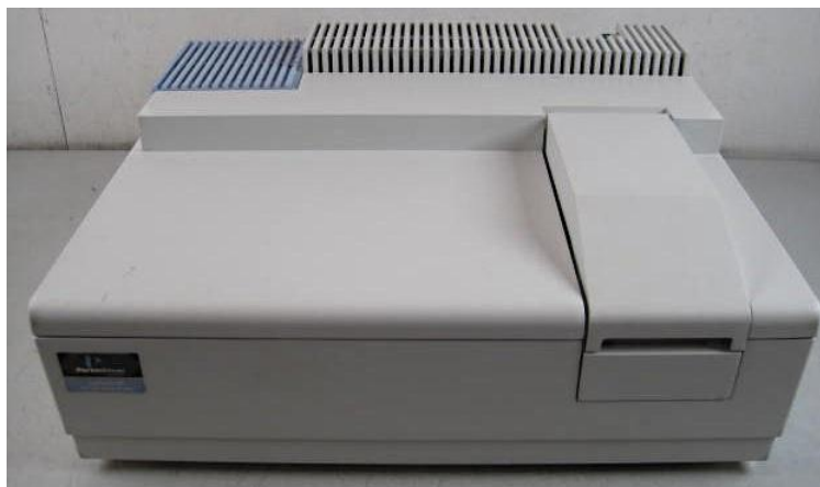
Εικόνα 6.11: Φασματοφωτοφωτομετρική διάταξη απορρόφησης, Perkin-Elmer Lambda 35 UV/VIS Spectrometer [42]
