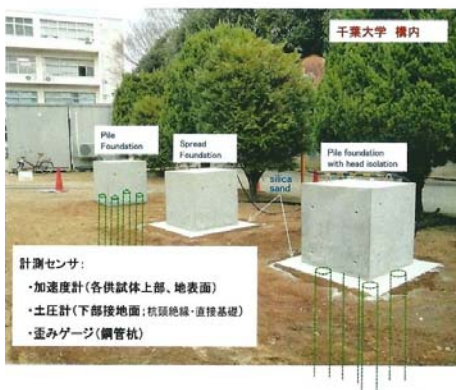
Σχήμα 1.12: Φωτογραφία και τομή των τριών πραγματικών συστημάτων θεμελίωσης που κατασκευάστηκαν στο ύπαιθρο για να μελετηθεί η απόκρισή τους από επιβολή σεισμικών διεγέρσεων, Kimata et al. (2012).
