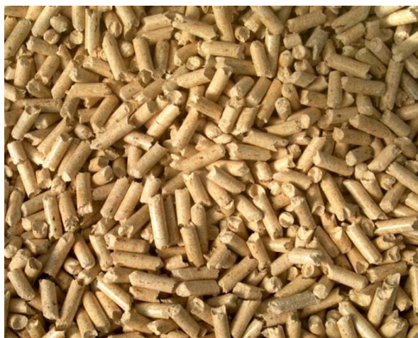
Εικόνα 6.2.1.1 Pellets (συσσωματώματα). Μηχανικά συμπιεσμένο πριονίδι, χωρίς πρόσθετα χημικά ή συγκολλητικές ουσίες.
