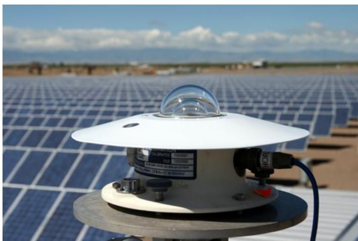
Εικόνα 6.1.1.2. Αισθητήρας θερμοηλεκτρικού τύπου (πυρανόμετρο)[23]
