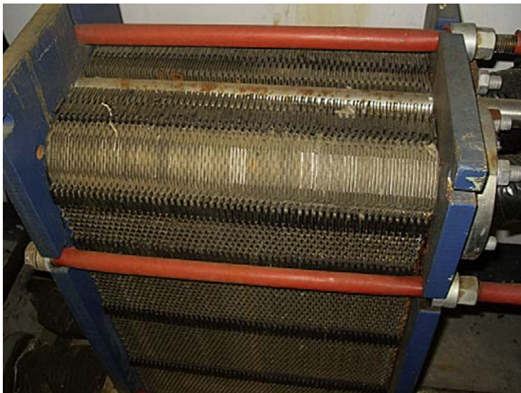
Εικόνα 6.1.3.3. Επίπεδος εναλλάκτης θερμότητας[26]
