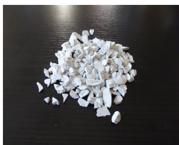
Εικόνα 5.1 Δείγμα λευκού φωτοκαταλυτικού τσιμέντου \text{TiO}_2 C95T5 i
