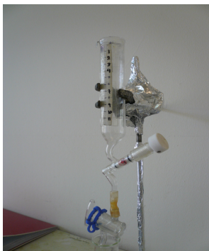
Εικόνα 5.3. Εργαστηριακή διάταξη που χρησιμοποιήθηκε για την εφαρμογή της τεχνικής leave-coating, η οποία χρησιμοποιήθηκε στα πλαίσια της παρούσας εργασίας.
