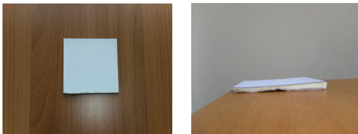
Εικόνα 5.4 Δείγμα λευκού νανοκρυσταλλικού υμενίου/στρώματος \text{TiO}_2 παρασκευασμένο από πάστα Degussa P25 στην επιφάνεια μεταλλικού πλακιδίου διαστάσεων 8cm x8cm, ZTi
