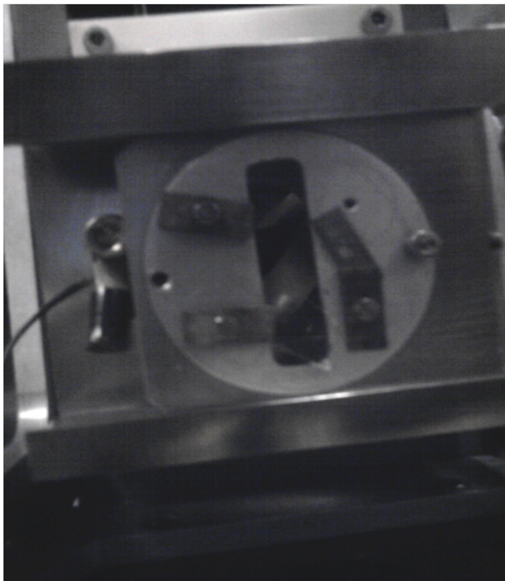
ΣΧΗΜΑ 3.4: Ο υποδοχέας που δέχεται έναν ή και παραπάνω στόχους ώστε να πραγματοποιηθούν πειραματικές μετρήσεις για ανάλυση στόχων
