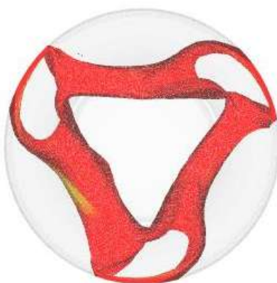
Εικόνα 36 Εξέλιξη της καύσης στον κινητήρα RT-flex58T-B, για λειτουργία σε μερικό φορτίο, 25%: ισοϋψείς καμπύλες της θερμοκρασίας σε επιφάνεια σταθερής συγκέντρωσης εξατμισθέντος καυσίμου, σε διαφορετικές τιμές της γωνίας στρόφαλου. Η επιφάνεια αντιστοιχεί στη στιγμιαία μέση τιμή της κατανομής της εν λόγω συγκέντρωσης.
