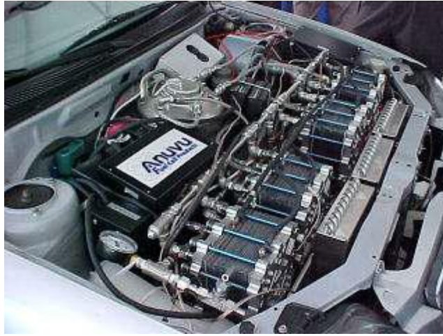
Εικόνα 5: Μηχανή αυτοκίνητου τροφοδοτούμενη από συστοιχία κυψελών καυσίμου PEMFC σε σειρά.
