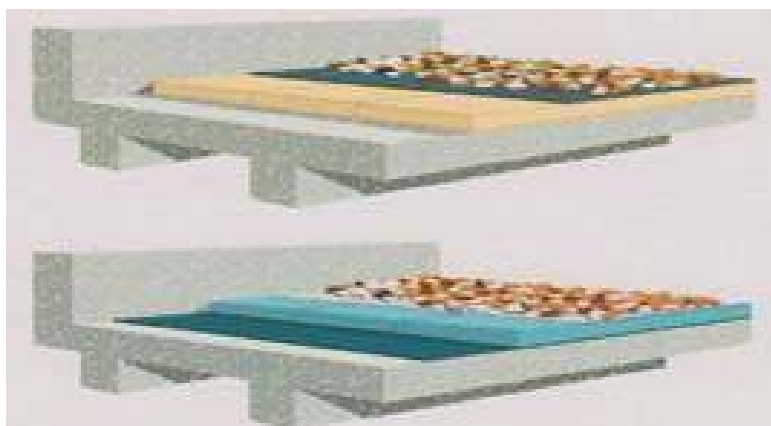
Εικόνα 7: Σύγκριση ανεστραμμένης και συμβατικής μόνωσης
