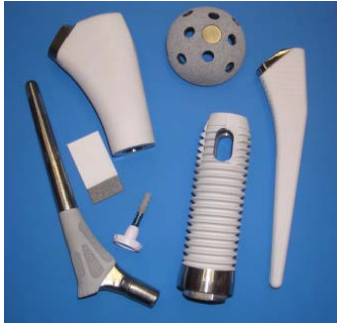
Σχήμα 2.05 Μοσχεύματα τιτανίου επικαλυμένα με υδροξυαπατίτη. Μία από τις βασικότερες εφαρμογές του υδροξυαπατίτη.
