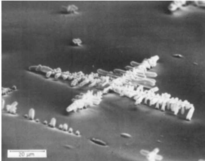
Σχήμα 3.14 : Εικόνα δευτερογενών ηλεκτρονίων ενός πυριτιούχου δενδρίτη σε κράμα νικελίου.
