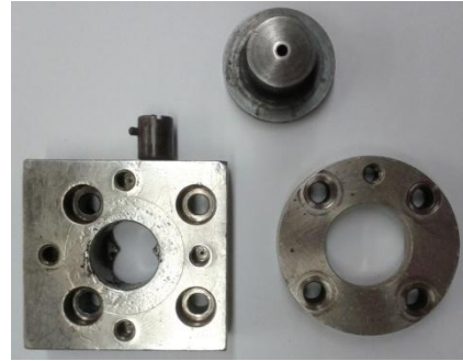
Εικόνα 3.6 Τα εξαρτήματα από τα οποία αποτελείται η μήτρα του εκβολέα.
