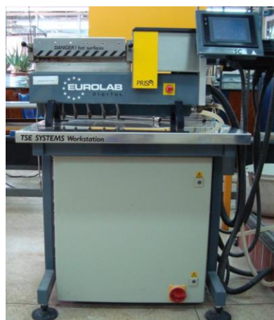
Εικόνα 3.3 Δεξιά πλάγια όψη εκβολέα. Διακρίνεται το χιτώνιο, το κιβώτιο ταχυτήτων και η οθόνη.
