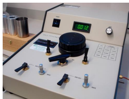
Εικόνα 4.2 Στερεοπυκνόμετρο ηλίου MVP-1 της Quantachrome.
