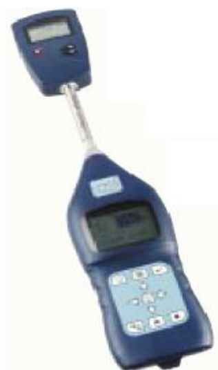
Διαδικασία καλιμπραρίσματος του ηχώμετρου( αριστερά) και όργανο καλιμπραρίσματος( δεξιά).
