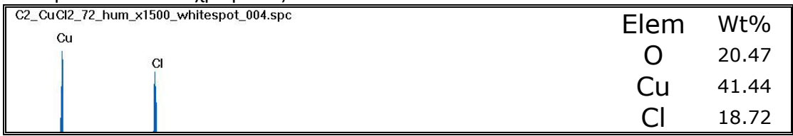
5-16 Πίνακας στοιχειακή ανάλυση από SEM του C2 σε σημείο της επιφάνειας του δοκιμίου «λευκού» χρώματος.
