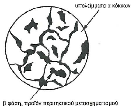
Σχήμα 1.9 Μικροδομή υποπεριτηκτικού κράματος που εμφανίζει υπολείμματα α φάσης μετά τον περιτηκτικό μετασχηματισμό.
