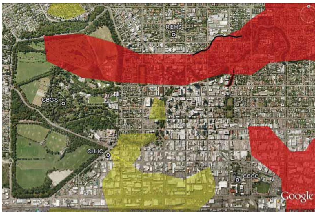
Εικόνα 3.11: εδαφικές εκτάσεις που ρευστοποιήθηκαν στο CBD του Christchurch από τον σεισμό της 22 ης Φεβρουαρίου του 2011. Με κόκκινο χρώμα απεικονίζονται οι περιοχές μέτριας έως έντονης ρευστοποίησης και με ανοιχτό πράσινο οι αντίστοιχες μέτριας προς χαμηλής (πηγή: Cubrinovski και McCahon, Αύγουστος 2011)
