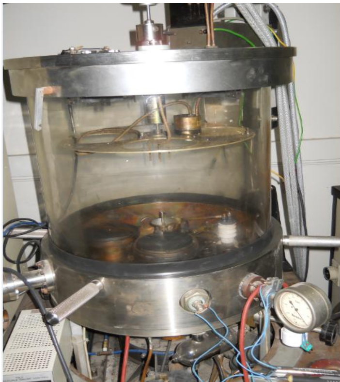
Εικ.1: Ο θάλαμος κενού της πειραματικής διάταξης. Διακρίνεται η βασική εσωτερική κατασκευή
