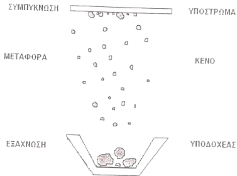
Σχήμα 3.1: Σχηματική περιγραφή της εξάχνωσης
