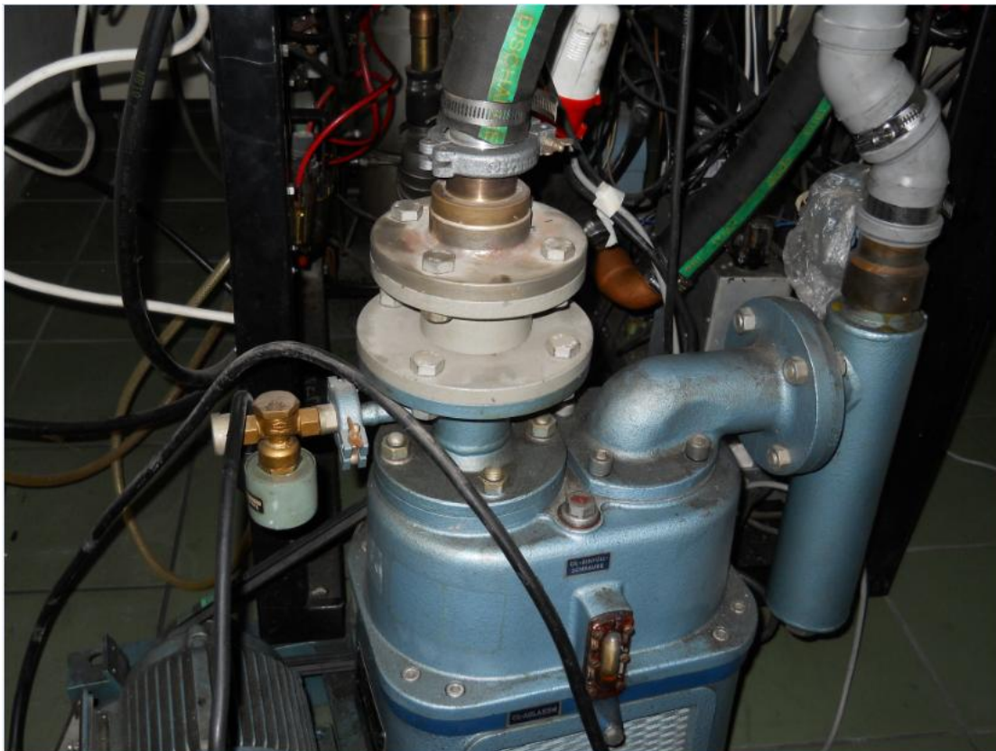
Εικ.4: Η μηχανική αντλία περιστροφής
