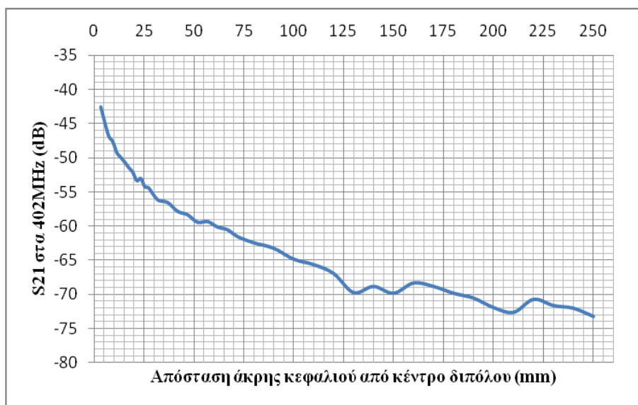
Σχ. 3.62 Διάγραμμα S_{21} στα 402MHz συναρτήσει της απόστασης μεταξύ κεφαλιού, στο οποίο είναι εμφυτευμένη PIFA κεραία, και διπόλου.
