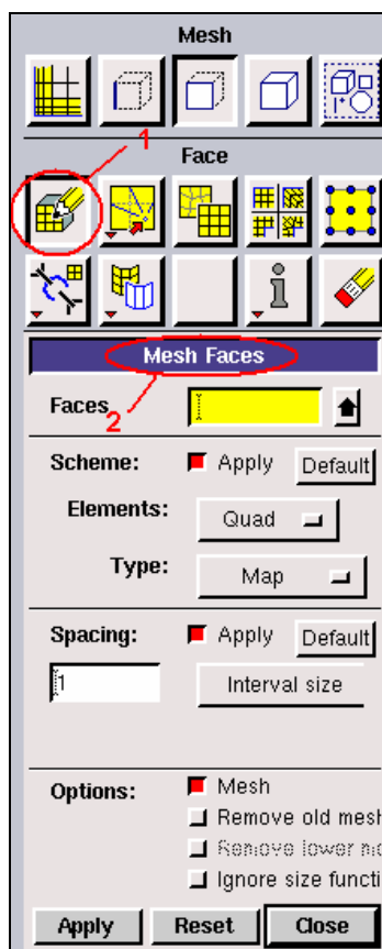
Σχήμα 3.9. «Παράθυρο» που εμφανίζεται κατά τη επιλογή της δημιουργίας υπολογιστικού πλέγματος σε επιφάνεια.
