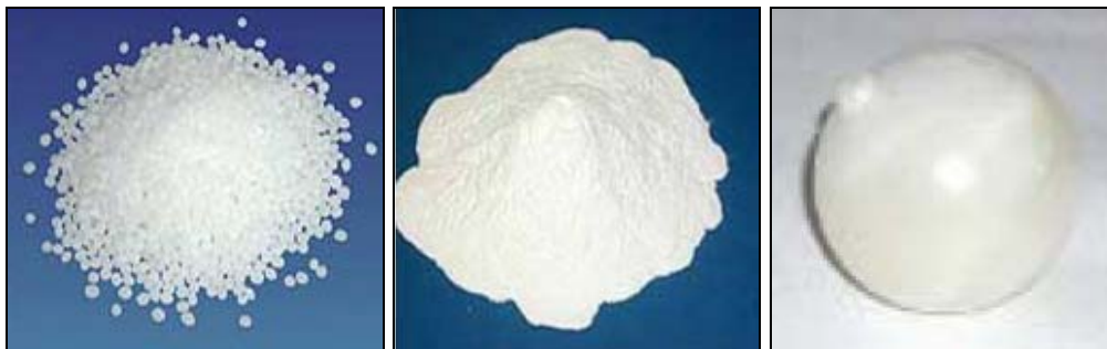
Σχήμα 1.8. α. Macroencapsulation σε παραφίνες, β. Microencapsulation σε παραφίνες, γ. Macroencapsulation , κάψουλα ένυδρου άλατος.
