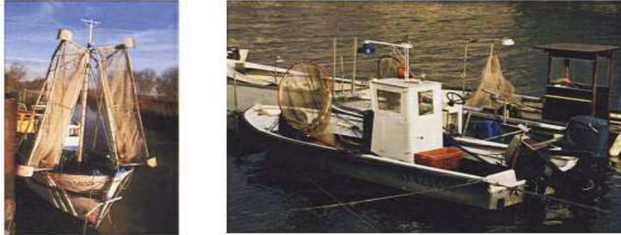
Εικόνα 1.4.1: Τράτες ( trawl nets ) με δύο τύπους αλιευτικών εργαλείων, για την αλιεία γυαλόχελου στις εκβολές των ποταμών της Γαλλίας (Feunteun et al. 2002).
