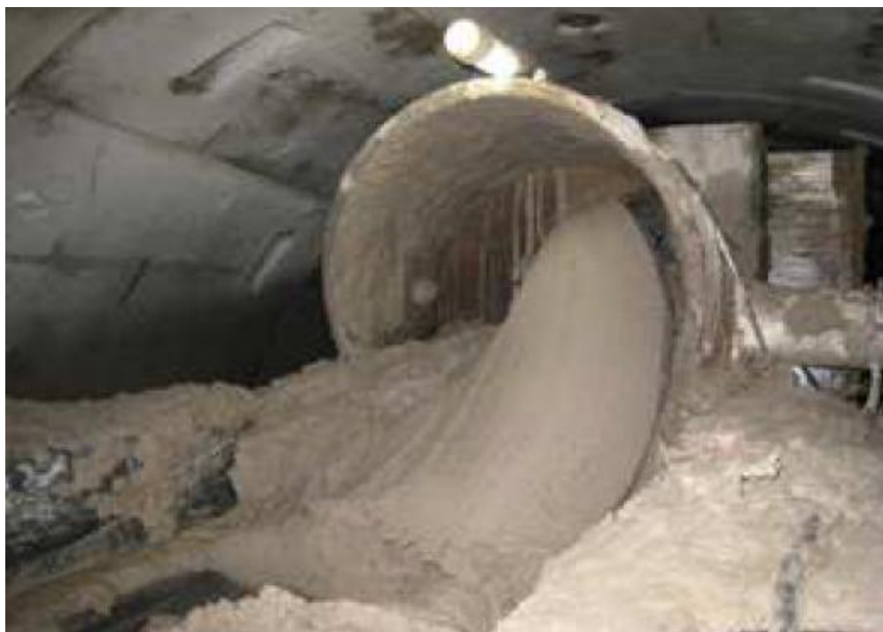
Εικόνα 1–17, Απαλλαγή του συσσωρευμένου υλικού μέσω της μεταφορικής ταινίας, Πηγή: Wallis P. 2009
