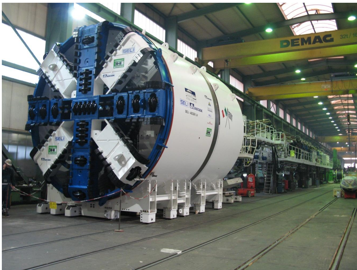
Εικόνα 3–2, Κοπτική κεφαλή EPB, Πηγή: Αττικό Μετρό
