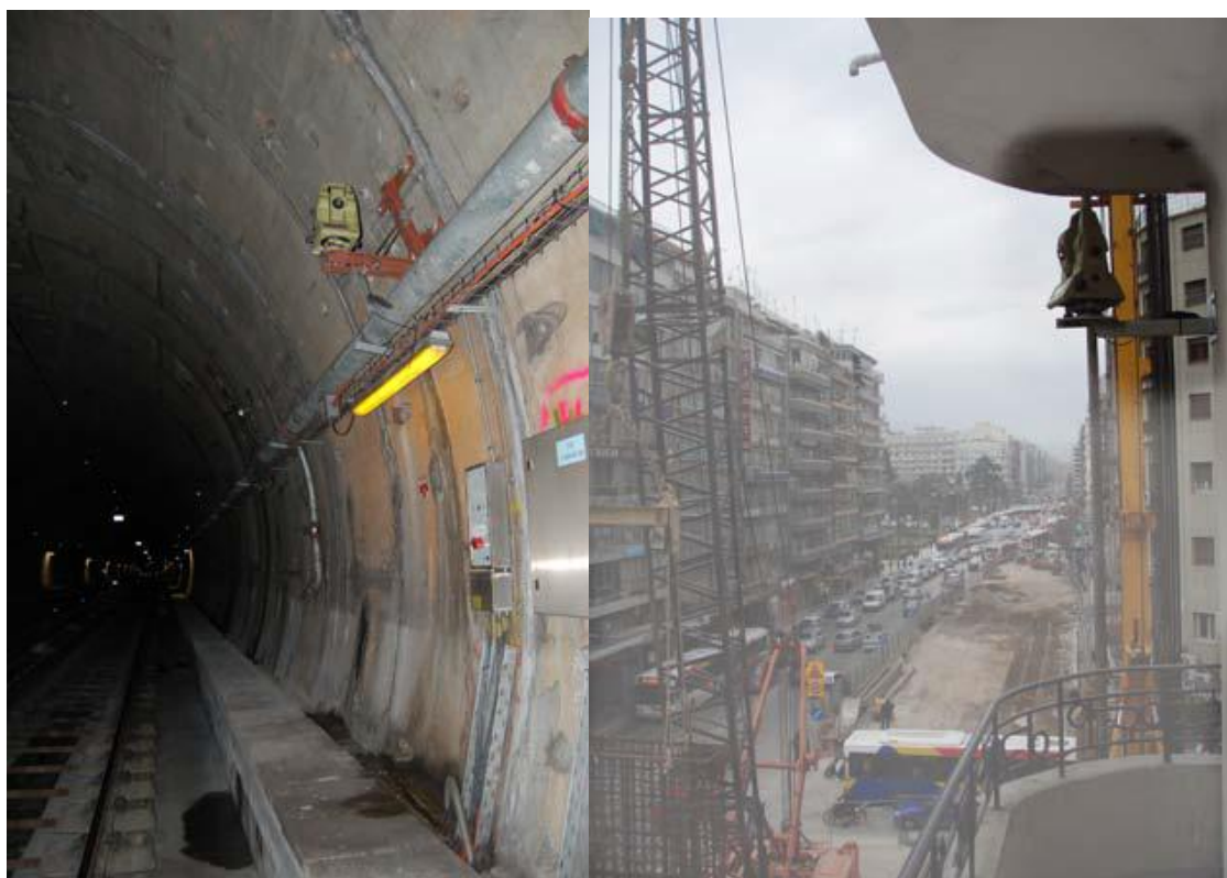
Εικόνα 4–2, Μετρητές παραμορφώσεων σε μέσα στη σήραγγα (αριστερά) και στην επιφάνεια(δεξιά), Πηγή: : K. Chmelina et al, 2009
