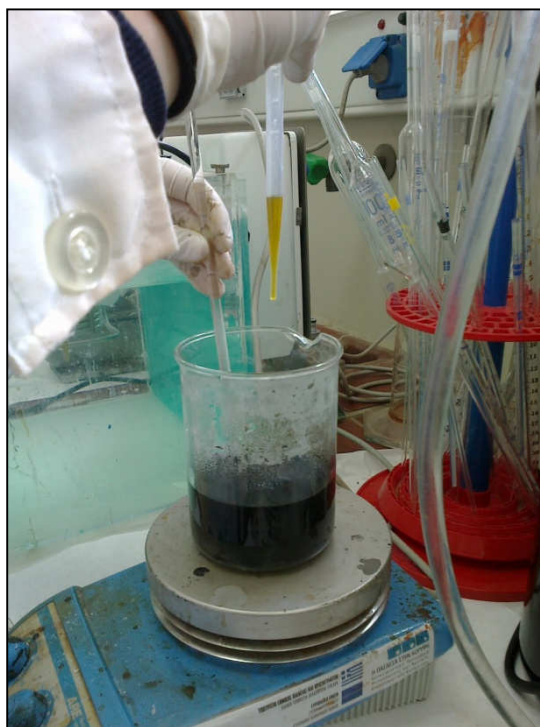
Εικόνα 18. Σύνθεση μαγνητίτη με την μέθοδο της χημικής συγκαταβύθισης.
