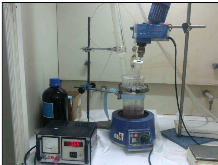
Εικόνα 2. Πειραματική διάταξη του πολυμερισμού αιωρήματος, PMMA/Fe 3 O 4 .
