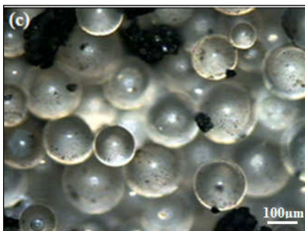
Εικόνα 17. Φωτογραφίες Οπτικού μικροσκοπίου των μικροσφαιρών PMMA/Fe 3 O 4 με διάμετρο κόκκου 125µm και ποσοστό ενσωμάτωσης μαγνητίτη (a) 1.25wt% (100x), (b) 1.40wt% (100x), (c) 2.85wt% (100x).
