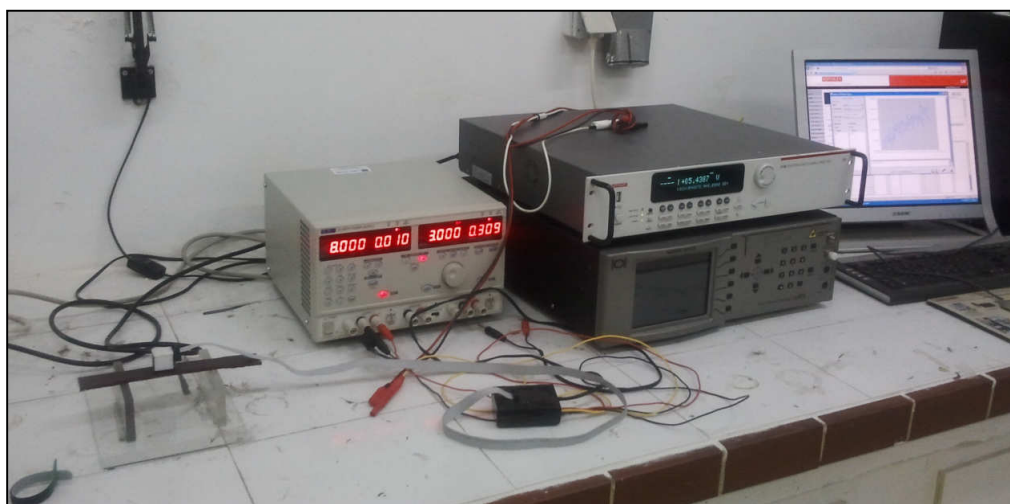
Εικόνα 8. Πειραματική διάταξη μετρήσεων της μεταβολής της πυκνότητας της μαγνητικής ροής ( B ), των συνθέτων υλικών πολυεστέρα/μαγνητίτη συναρτήσει του χρόνου.
