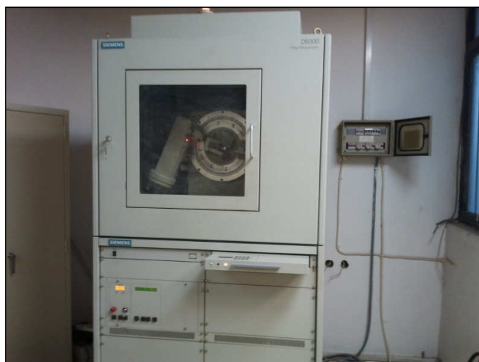
Εικόνα 3. Συσκευή περίθλασης ακτίνων-X Siemens D5000 X-Ray Diffractometer.
