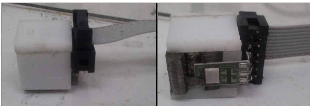
Εικόνα 10. Σύστημα μόνιμου μαγνήτη (NdFeB) – αισθητήρα Hall
