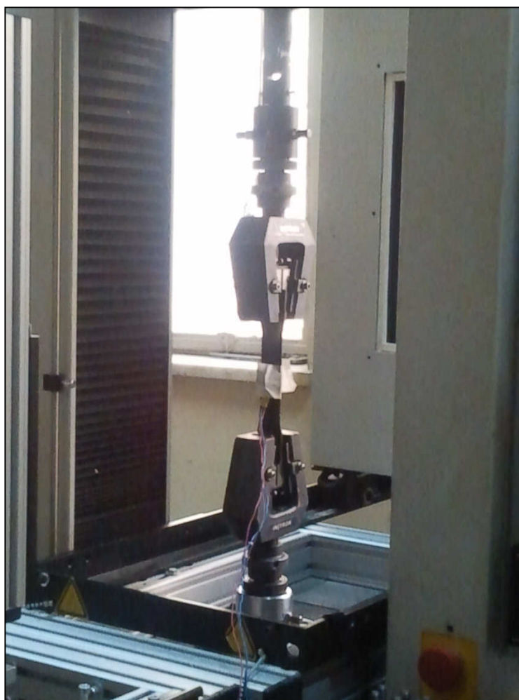
Εικόνα 28. Πείραμα εφελκυσμού στη μηχανή INSTRON με ταυτόχρονη επιβολή μαγνητικού πεδίου.
