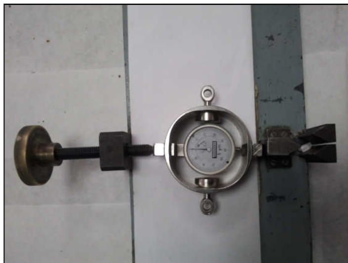
Εικόνα 13. Διάταξη μέτρησης αντοχής σε κάμψη και διάτμηση, επιμηκυνσιόμετρο TIEDEMANN.
