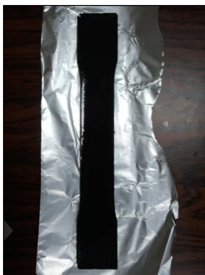
Εικόνα 22. Δοκίμιο συνθέτου μήτρας πολυεστέρα και πρόσθετο μαγνητίτη.
