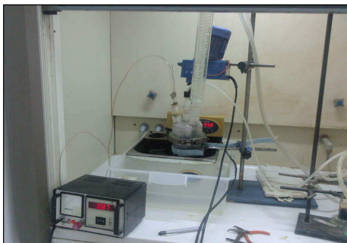
Εικόνα 20. Πειραματική διάταξη του πολυμερισμού αιωρήματος πολυστυρενίου-διβινυλοβενζολίου.
