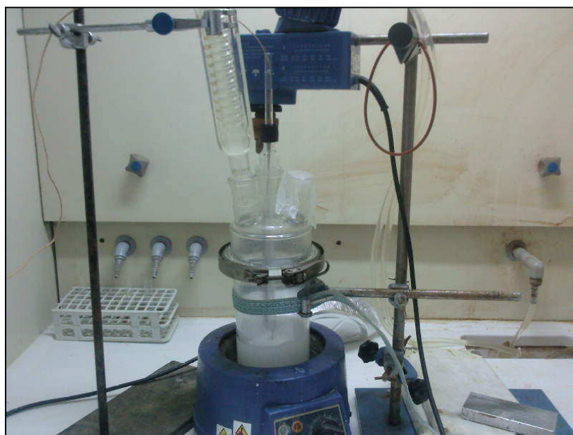
Εικόνα 1. Πειραματική διάταξη του πολυμερισμού αιωρήματος.
