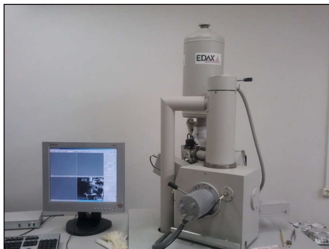
Εικόνα 4. Ηλεκτρονικό μικροσκόπιο σάρωσης SEM.
