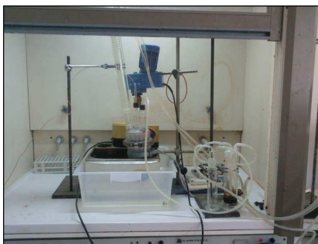
Εικόνα 21. Πειραματική διάταξη πολυμερισμού αιωρήματος PS-DVB/ \text{Fe}_3\text{O}_4 .
