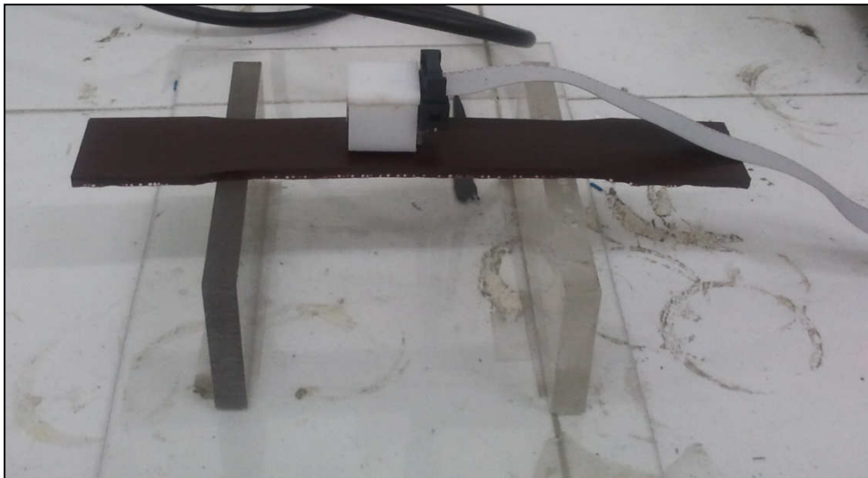
Εικόνα 12. Κλειστό μαγνητικό κύκλωμα δοκίμιο-μόνιμος μαγνήτης-αισθητήρας Hall.
