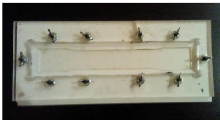
Εικόνα 1. Καλούπι Teflon διαστάσεων (75x25x3) mm.
