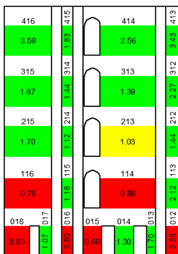
Σχήμα 30: Αστοχίες από διάτμηση στον εσωτερικό κεντρικό τοίχο
