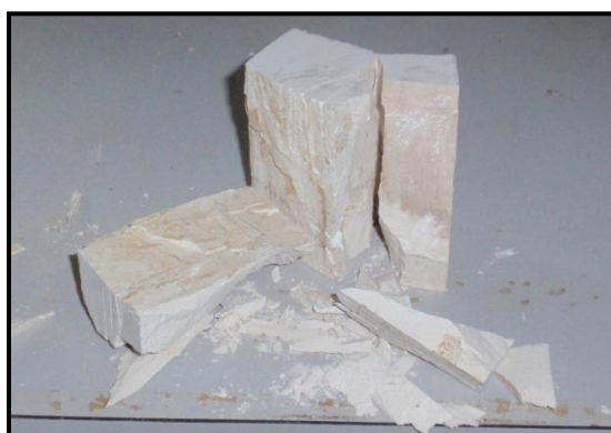
Εικόνα 29: Τρόπος αστοχίας λιθοσώματος
