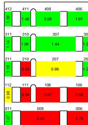
Σχήμα 57: Αστοχίες από διάτμηση στον εσωτερικό τοίχο πλησίον της ανατολικής όψης
