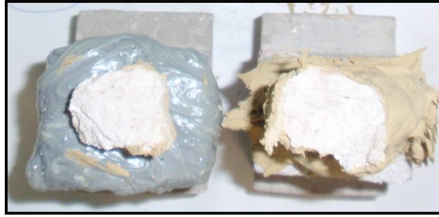
Εικόνα 32: Τρόπος αστοχίας κονιαμάτων
