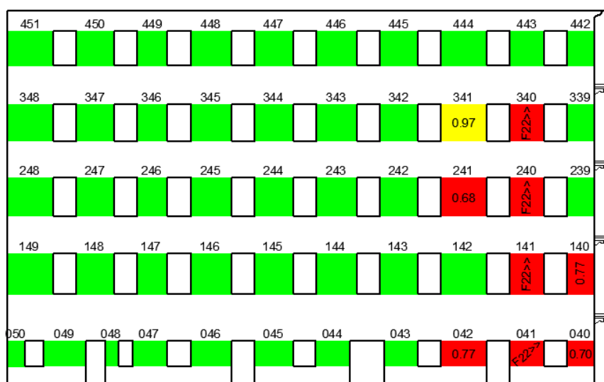
Σχήμα 32: Αστοχίες από διάτμηση στη νότια όψη εξαιτίας της καθίζησης
