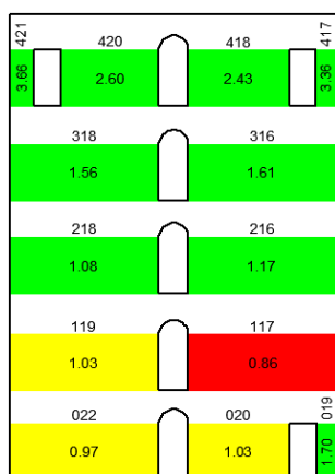
Σχήμα 88: Αστοχίες από διάτμηση στον εσωτερικό τοίχο πλησίον της δυτικής όψης
