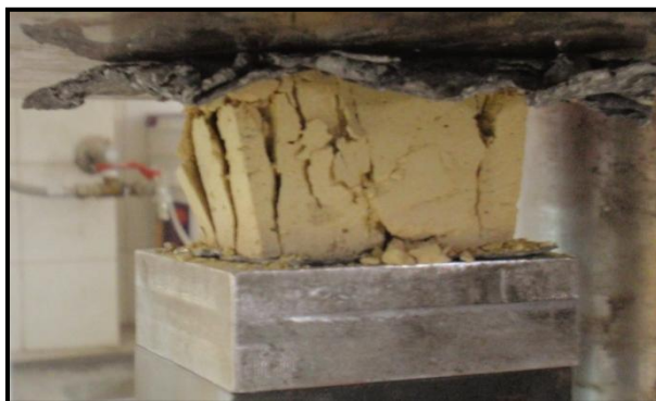
Εικόνα 30: Τρόπος αστοχίας οπτόπλινθων
