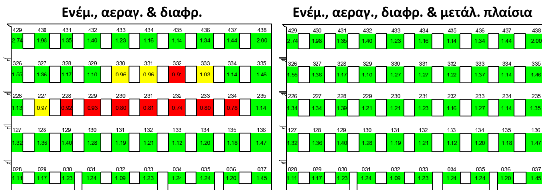
Σχήμα 84: Αστοχίες από διάτμηση στη βόρεια όψη
