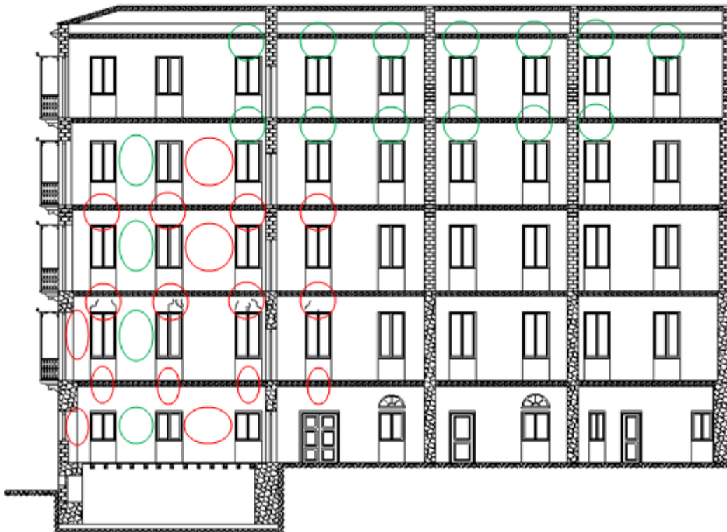
Σχήμα 45: Αποτυπωμένη παθολογία τομής ΣΤ-ΣΤ' και αστοχίες σύμφωνα με την ανάλυση του SAP2000
