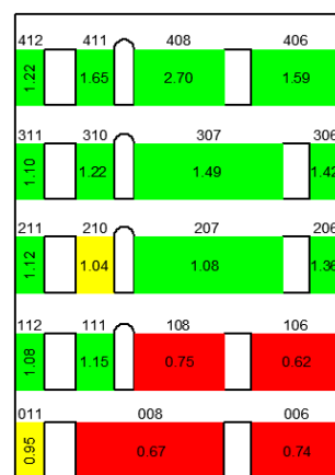
Σχήμα 78: Αστοχίες από διάτμηση στον εσωτερικό τοίχο πλησίον της ανατολικής όψης
