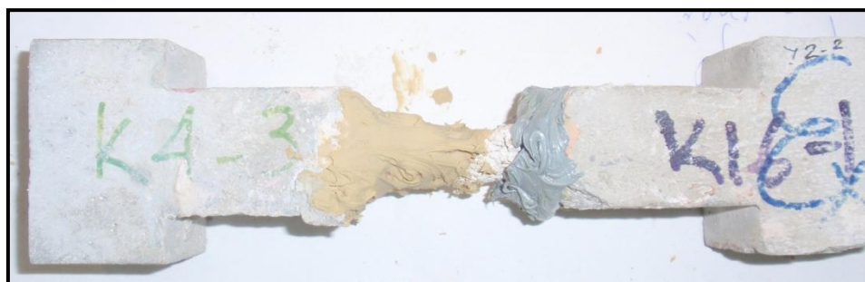
Εικόνα 31: Διάταξη δοκιμίου κονιάματος
