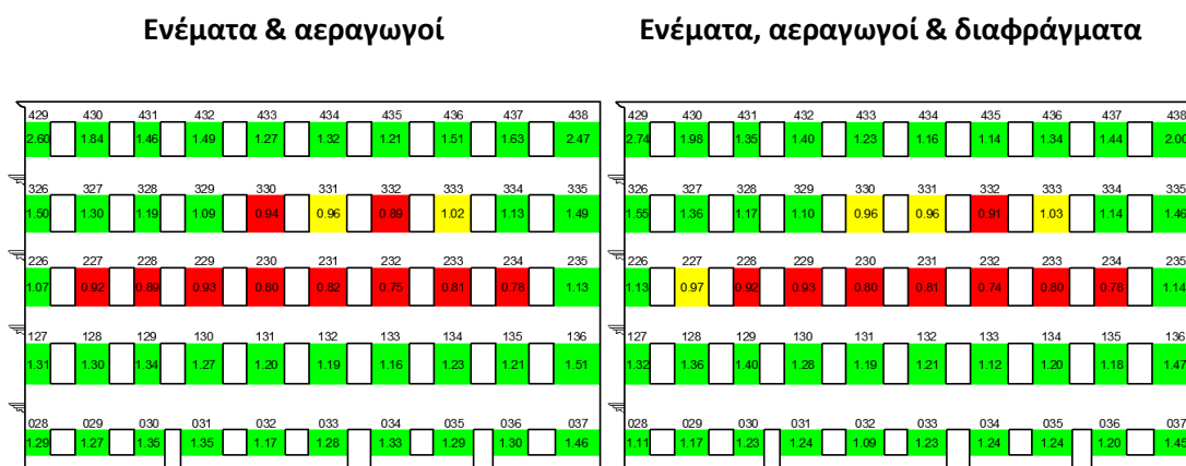
Σχήμα 75: Αστοχίες από διάτμηση στη βόρεια όψη
