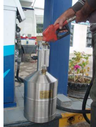
Σχήμα 41: Μετρητικό συγκρότημα αντλίας πρατηρίου και διαδικασία ελέγχου του με χρήση λιτρομέτρου.
