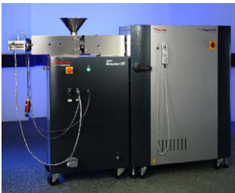
Σχήμα 3. 4. Δικόχλιος Εκβολέας Haake της Εταιρείας Thermo Fisher Scientific Inc
