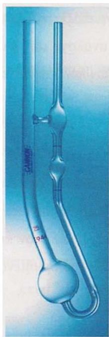
Σχήμα 3.7.: Ιξωδόμετρο τριχοειδούς τύπου Cannon-Fenske(350)
