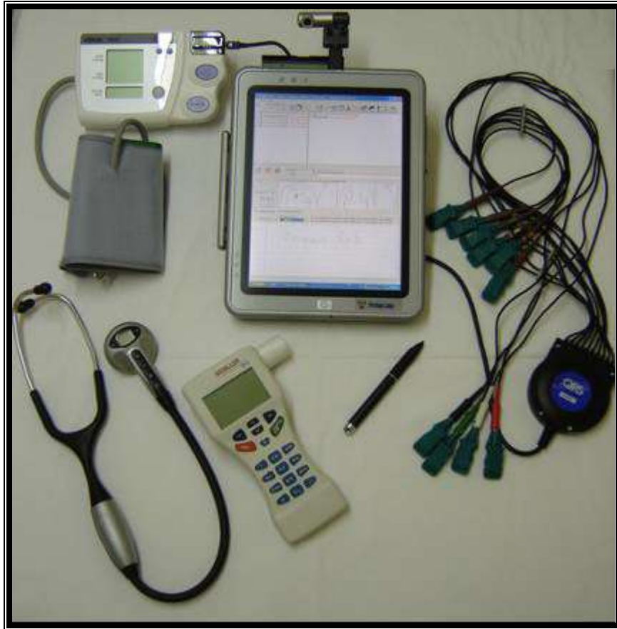
Εικόνα 1.4 : (Ψηφιακό πιεσόμετρο, σπιρόμετρο, ψηφιακό στηθοσκόπιο, και αρκετά άλλα εξειδικευμένα περιφερειακά επικοινωνούν είτε ασύρματα είτε ενσύρματα με τον φορητό ηλεκτρονικό υπολογιστή (ο οποίος, μάλιστα διαθέτει ενσωματωμένη κάμερα για χρήση σε εφαρμογές τηλεδιάσκεψης ) της μονάδας τηλεϊατρικής [27].
