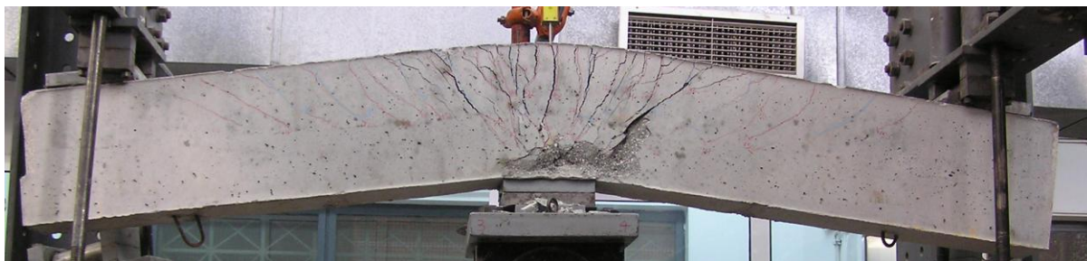
Εικόνα 13: Δοκός Δ1: αστοχία δοκιμίου υπό Μονότονη Φόρτιση
