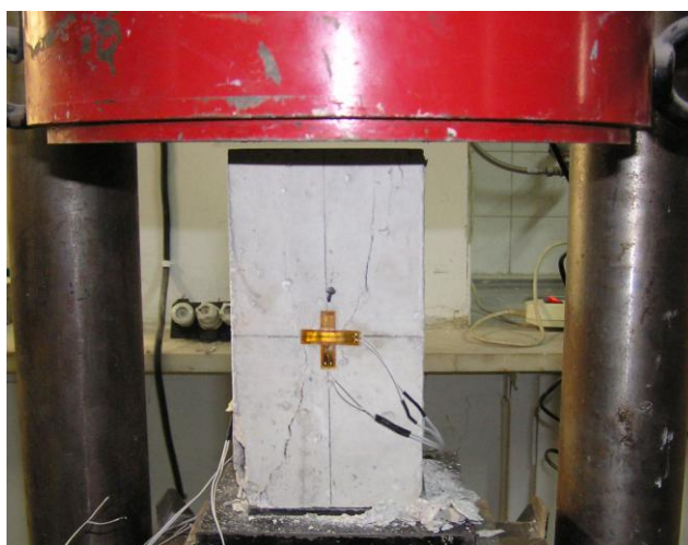
Εικόνα 8: Πρισματικό δοκίμιο ελαφροσκυροδέματος σε δοκιμή προσδιορισμού του Μέτρου Ελαστικότητας
