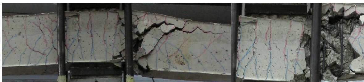
Εικόνα 25: Δοκός Δ6: Ρηγματωμένη κατάσταση φορέα μετά τη διαρροή
