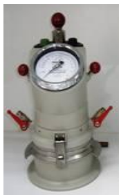
Εικόνα 3: Διάταξη μέτρησης περιεχόμενου αέρα
