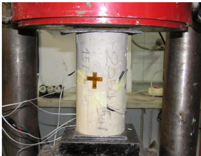
Εικόνα 9: Πρισματικό δοκίμιο ελαφροσκυροδέματος σε δοκιμή προσδιορισμού του Μέρους Ελαστικότητας
