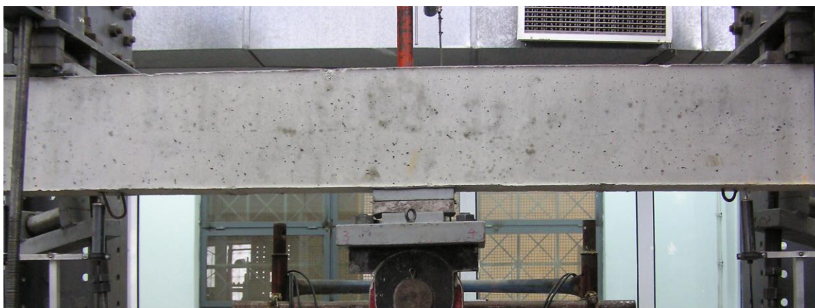
Εικόνα 10: Πειραματική Διάταξη επιβολής μονότονης φόρτισης (Δοκοί Δ1 & Δ2)
