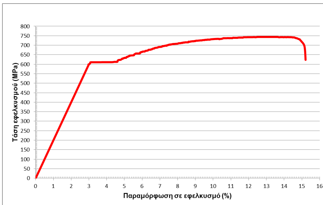
Σχήμα 18: Διάγραμμα τάσεων - ανηγμένων παραμορφώσεων χάλυβα Φ14
