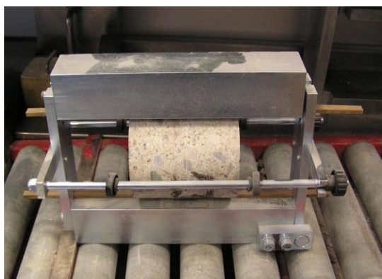
Εικόνα 6: Διάταξη δοκιμής σε διάρρηξη (Brazilian Test) κυλινδρικού δοκιμίου
