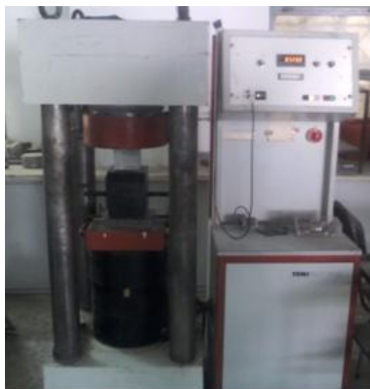
Εικόνα 5: Μηχανή δοκιμής σε μονοαξονική θλίψη-Εργαστήριο Οπλισμένου Σκυροδέματος ΕΜΠ
