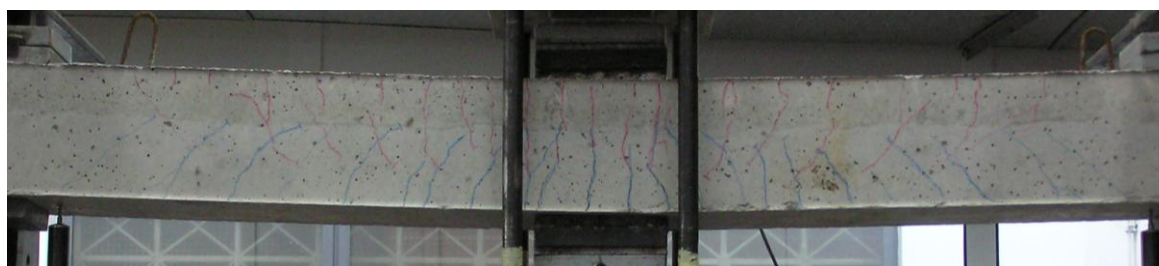
Εικόνα 24: Δοκός Δ6: Ρωγμές εντός διαμητικού μήκους. Συγκέντρωση ρωγμών στο σημείο επιβολής της φόρτισης
