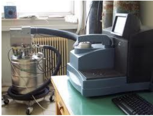
Εικόνα 2.1: Το θερμιδόμετρο Q200 της TA μαζί με τη συσκευή που ελέγχει τη ροή υγρού αζώτου (LNCS) η οποία φαίνεται στιβαρότερα της εικόνας.[6]
