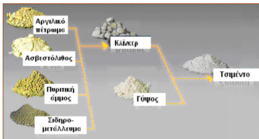
Σχήμα 2.3 Πρώτες ύλες και ενδιάμεσα για την παραγωγή τσιμέντου [1].
