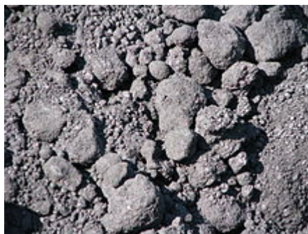
Σχήμα 3.3: Σωρός petcoke έτοιμος για κοσκίνισμα ώστε να φτάσει στην κατάλληλη κοκκομετρία καύσης [10].
