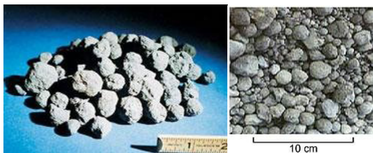
Σχήμα 2.1 Σφαιρίδια κλίνκερ προϊόν πυροσυσσωμάτωσης [1].
