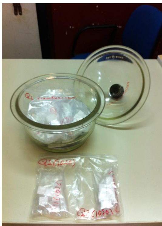
Εικόνα 10.3: Διατήρηση των ασβεστοποιημένων δοκιμίων σε ξηραντήρα.
