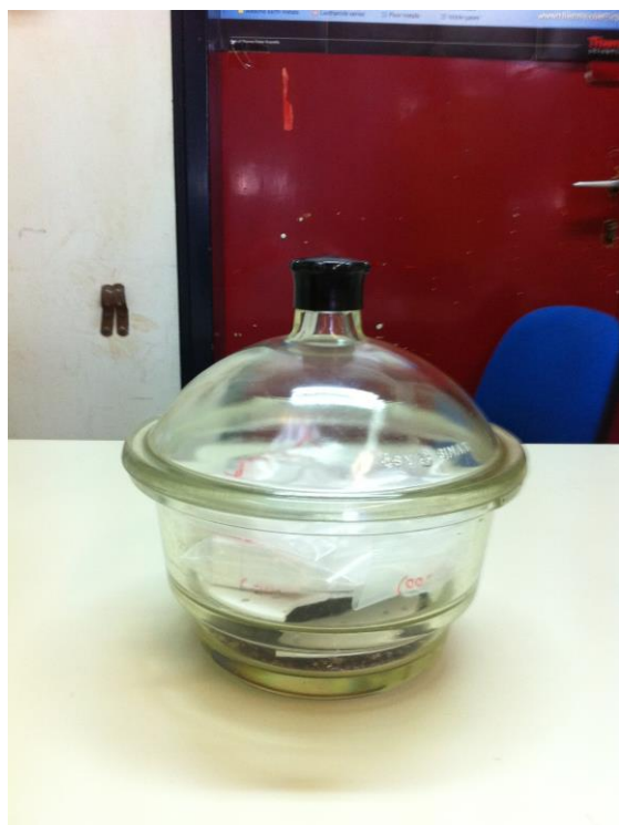
Εικόνα 10.3: Διατήρηση των ασβεστοποιημένων δοκιμίων σε ξηραντήρα.
