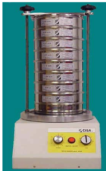
Εικόνα 8.2: Συσκευή κοσκίνησης (μοντέλο RP08).
