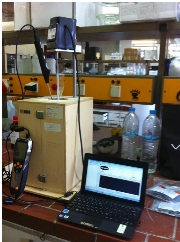
Εικόνα 12.2: Πειραματική διάταξη μέτρησης δραστηριότητας ασβέστη (κατά την διάρκεια της αντίδρασης \text{CaO} + \text{H}_2\text{O} ).
