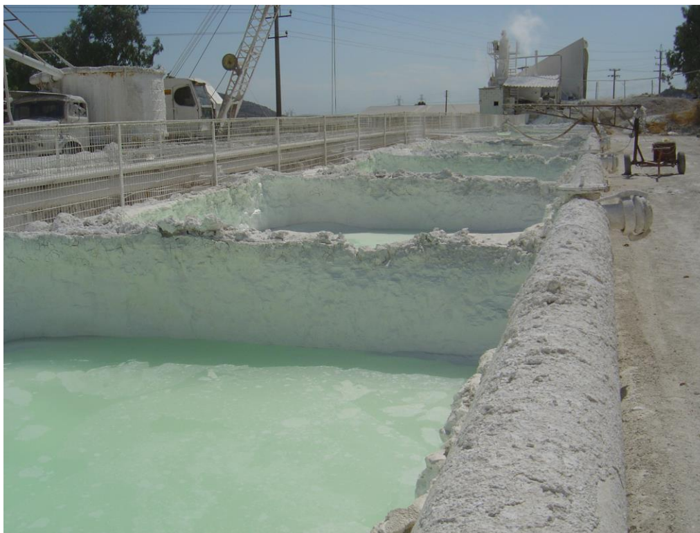
Εικ. 4.2: Παράδειγμα διαδοχικών ασβεστόλακκων. Διακρίνεται ο πρώτος ο οποίος περιέχει νερό για τη διαδικασία της ενυδάτωσης του ασβέστη.
