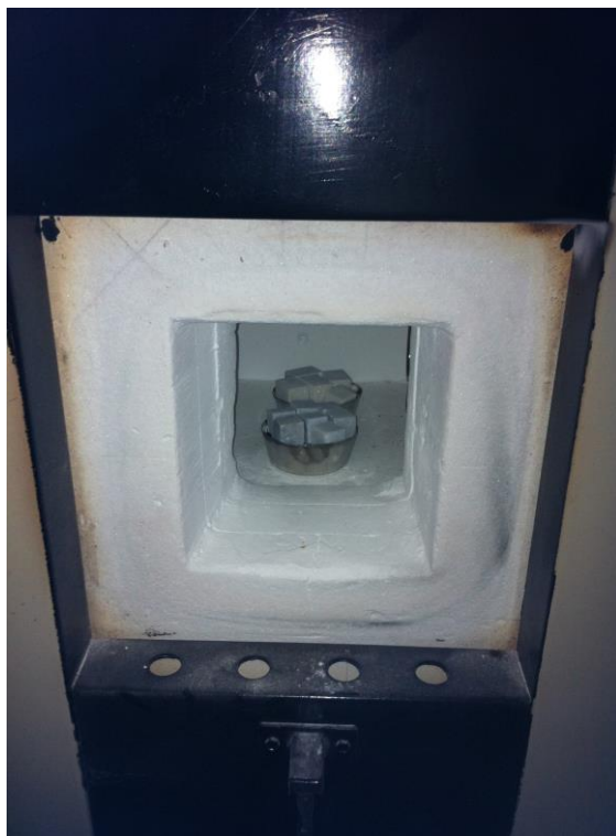
Εικόνα 10.2: Εισαγωγή των δειγμάτων στο φούρνο ( χωνευτήριο πλατίνας με ανθρακικό πέτρωμα).
