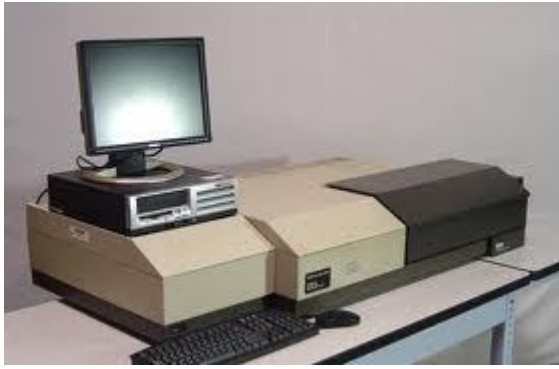
Εικόνα 2.1: Φασματοόμετρο Perkin Elmer Lambda 19 UV/Vis/NIR και εξάρτημα μέτρησης της ανακλαστικότητας.
