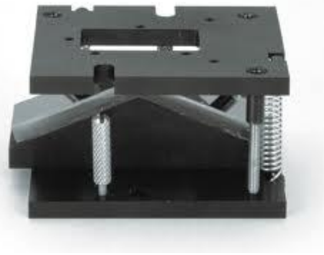
Εικόνα 2.1: Φασματοόμετρο Perkin Elmer Lambda 19 UV/Vis/NIR και εξάρτημα μέτρησης της ανακλαστικότητας.
