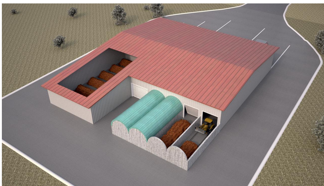
Σχήμα 5.5. Προοπτική απεικόνιση της Μονάδας Κομποστοποίησης. Τομή των κιβωτίων αποδόμησης και του κλειστού χώρου ωρίμανσης σε σειράδια.
