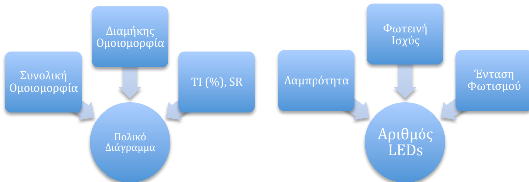
Σχήμα 2-1: Διαδικασία σχεδιασμού του πολικού διαγράμματος και επιλογής του απαιτούμενου αριθμού LEDs του φωτιστικού.
