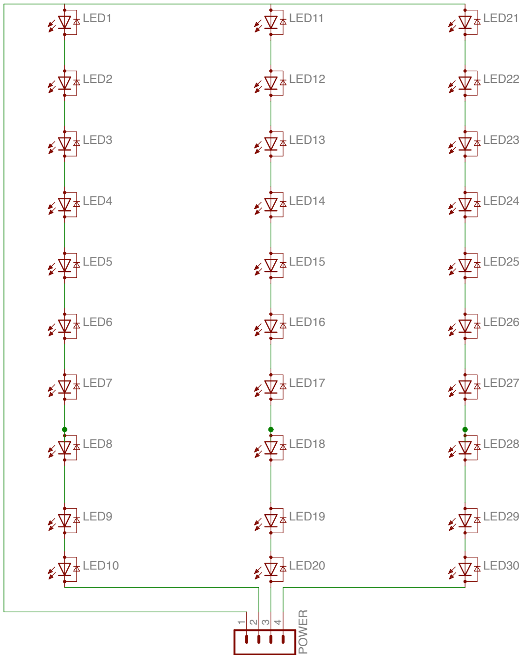
Εικόνα 5-11: Σχηματικό του κυκλώματος των LEDs.
