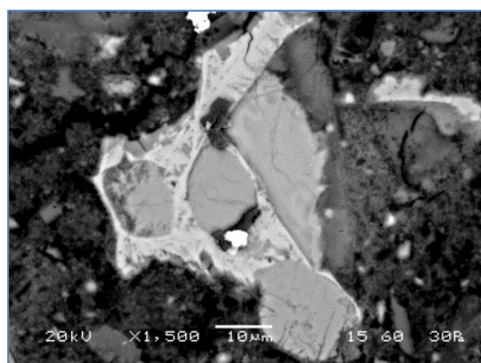
Σχήμα 5-74: Εικόνες SEM κονιαμάτων PMC μετά τη θερμική κατεργασία στους 600°C
