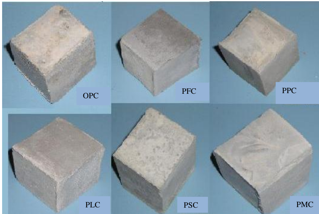
Σχήμα 5-1: Δοκίμια παστών μετά από θερμική κατεργασία στους 200°C
