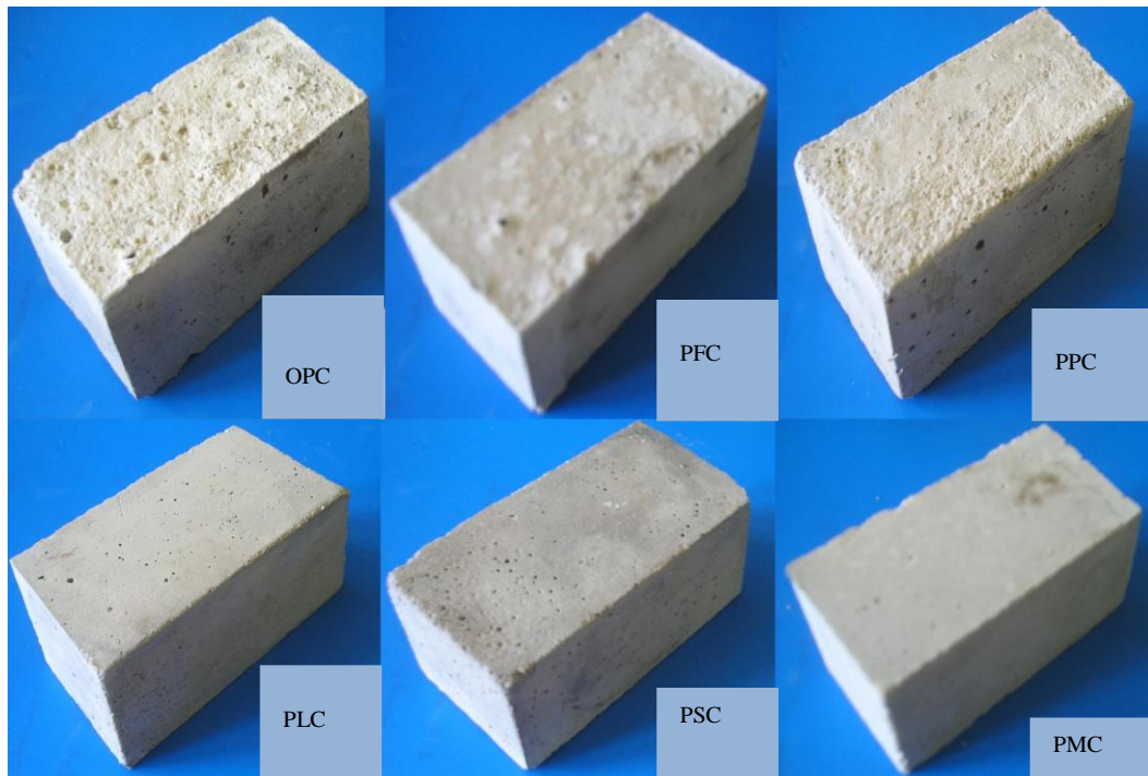
Σχήμα 5-51: Δοκίμια κονιαμάτων με πυριτική άμμο μετά από θερμική κατεργασία στους 400°C
