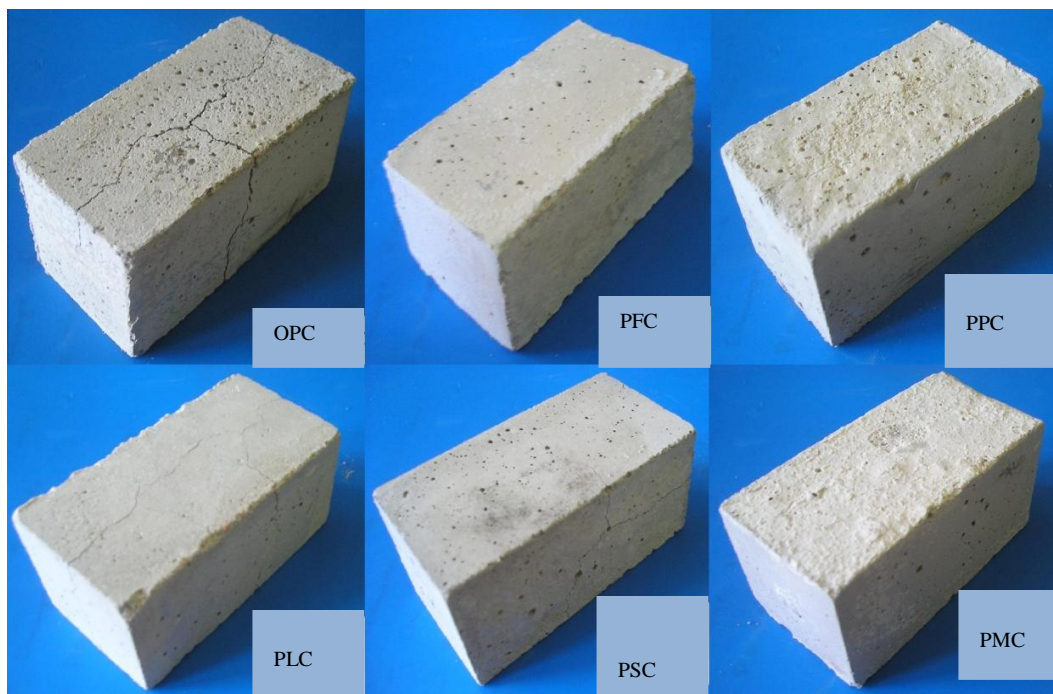
Σχήμα 5-52: Δοκίμια κονιαμάτων με πυριτική άμμο μετά από θερμική κατεργασία στους 600°C
