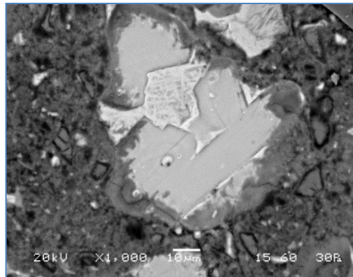
Σχήμα 5-73: Αναλύσεις SEM κονιαμάτων PMC μετά την περίοδο ωρίμανσης (25°C)
