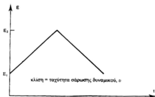
Σχήμα 16: Μεταβολή εφαρμοζόμενου δυναμικού με το χρόνο σε πείραμα κυκλικής βολταμμετρίας.
