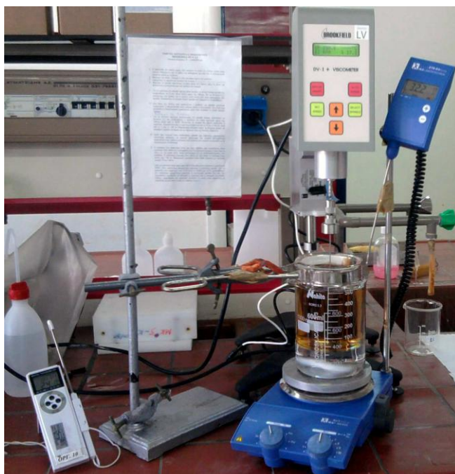
Εικόνα 12: Διάταξη μέτρησης ιξώδους του [Emim]HSO 4 .
