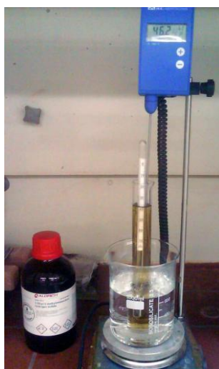
Εικόνα 11 : Διάταξη μέτρησης πυκνότητας του [Emim]HSO 4 .
