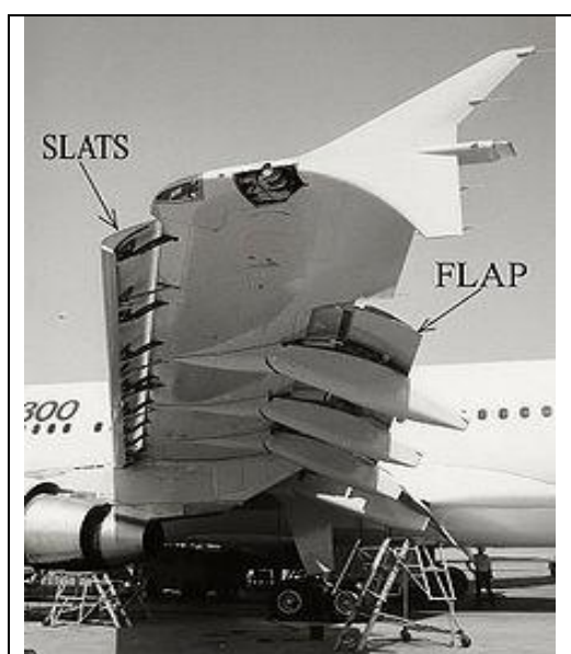
Σχήμα 1.1 Διάταξη των flap και slat σε μία πτέρυγα αεροσκάφους.
