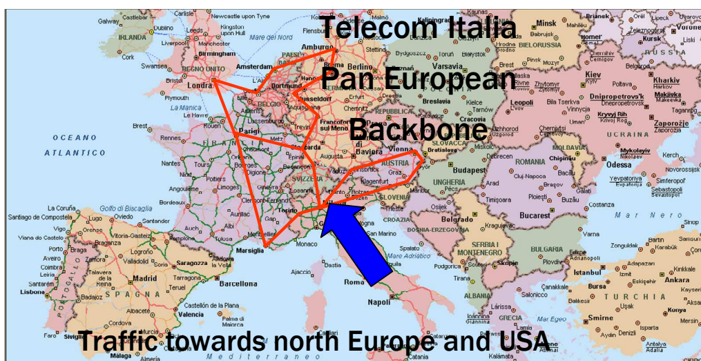
Σχήμα 9: Σχηματική απεικόνιση δρομολόγησης δεδομένων προς διεθνές Ευρωπαϊκό δίκτυο κορμού.
