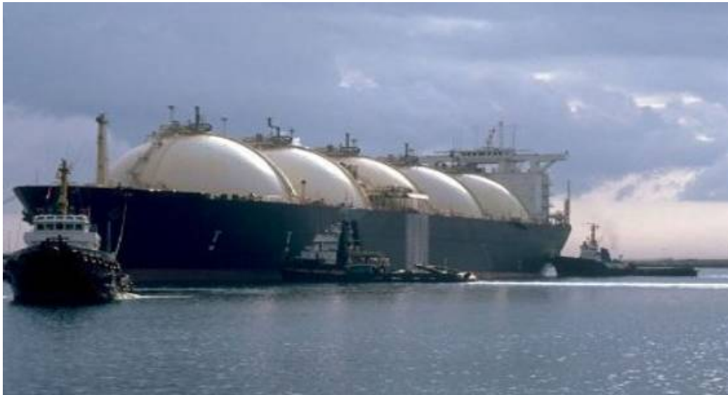
Σχήμα 2.2: Σε πλοία μεταφοράς υγροποιημένου φυσικού αερίου εμφανίζονται φαινόμενα sloshing(Πηγή: timriley.com)
