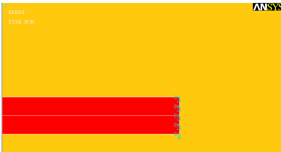
Εικόνα 2.19. Περιορισμός όλων των βαθμών ελευθερίας εκτός από την διεύθυνση ux στη πλευρά επιβολής της μετατόπισης.
