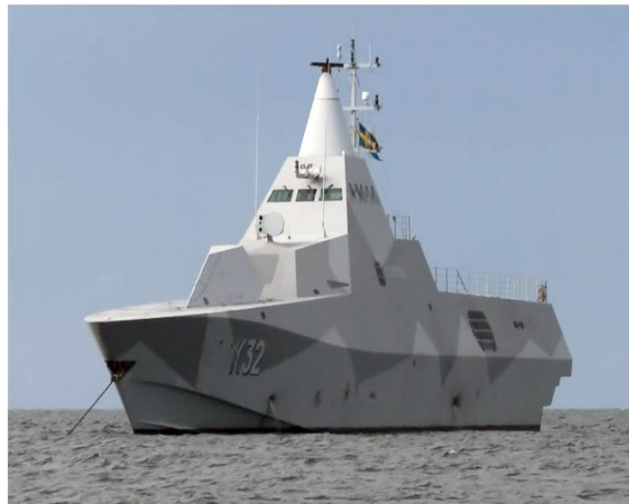
Εικόνα 1.3. Κορβέτα του Σουηδικού Ναυτικού κατασκευασμένη από sandwich με πυρήνα από αφρό PVC και ίνες άνθρακα .
