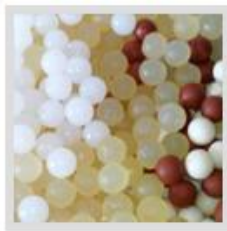
5-3 Σφαιρικές κάψουλες αποθήκευσης ΥΑΦ
